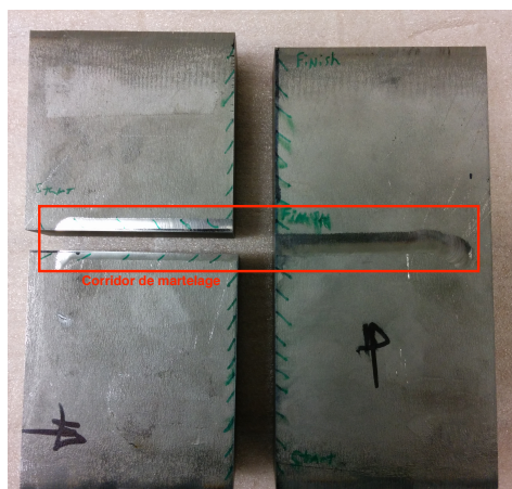
Figure 2.5 Plaque d'acier 304L martelée en ligne droite selon des paramètres opérationnels typiques, puis découpée pour l'analyse des contraintes
