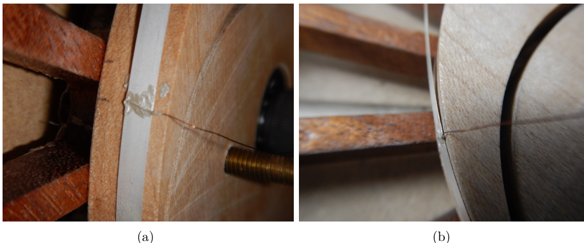
Figure 5.11 Photographies illustrant la mise en place des prises de mesure du potentiel électrique à l'aide d'un fin fil de cuivre et de peinture d'argent.
