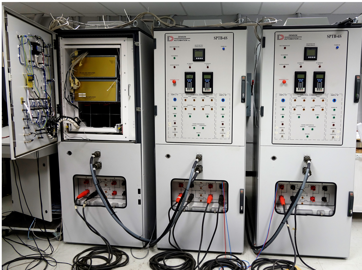
Figure 5.22 Système d'amplificateur disponible au laboratoire. On dispose de 6 amplificateurs de puissance de 50 kW chacun (max. 350 V_{pk} et 200 A_{rms} par amplificateur).
