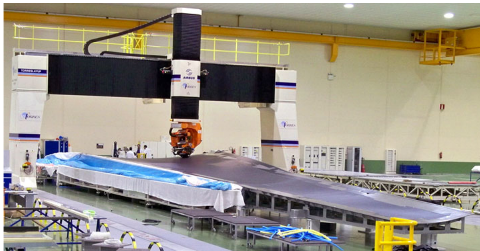
Figure 2.2 Portique de placement automatisé de bande (MTorres®)
