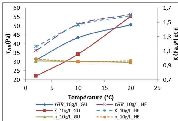
Figure 4.29 : Effet du type de ciment sur les propriétés rhéologiques des mélanges RCPS Goldex ( $C_w = 76,3\%$ ) à une concentration en sel de 10 g/L à des températures 2, 10 et 20°C.
