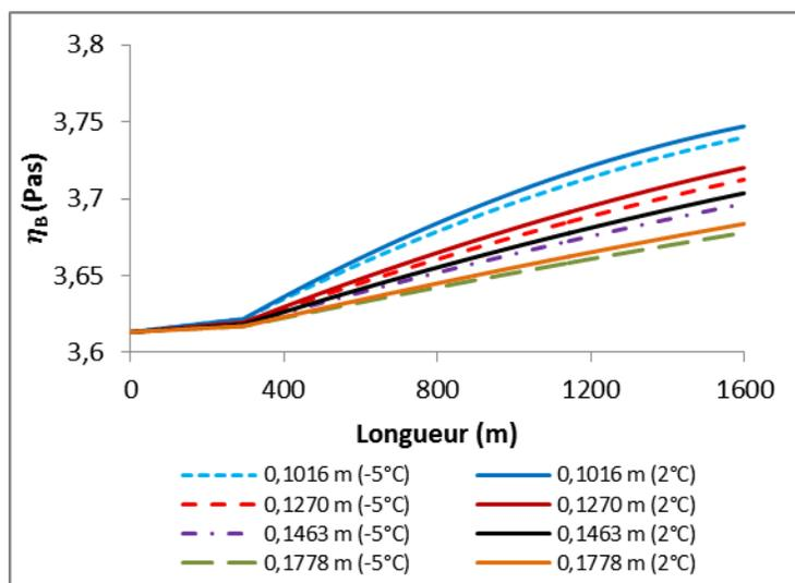
Figure Q. 5 : Variations  $\eta_B$  du RCPS en écoulement à la vitesse de 1,5 m/s dans le réseau de distribution de diamètres internes de 0,1016 m , 0,1270 m , 0,1463 m et 0,1778 m à des températures extérieures souterraines de  $-5^{\circ}\text{C}$  et  $2^{\circ}\text{C}$ .
