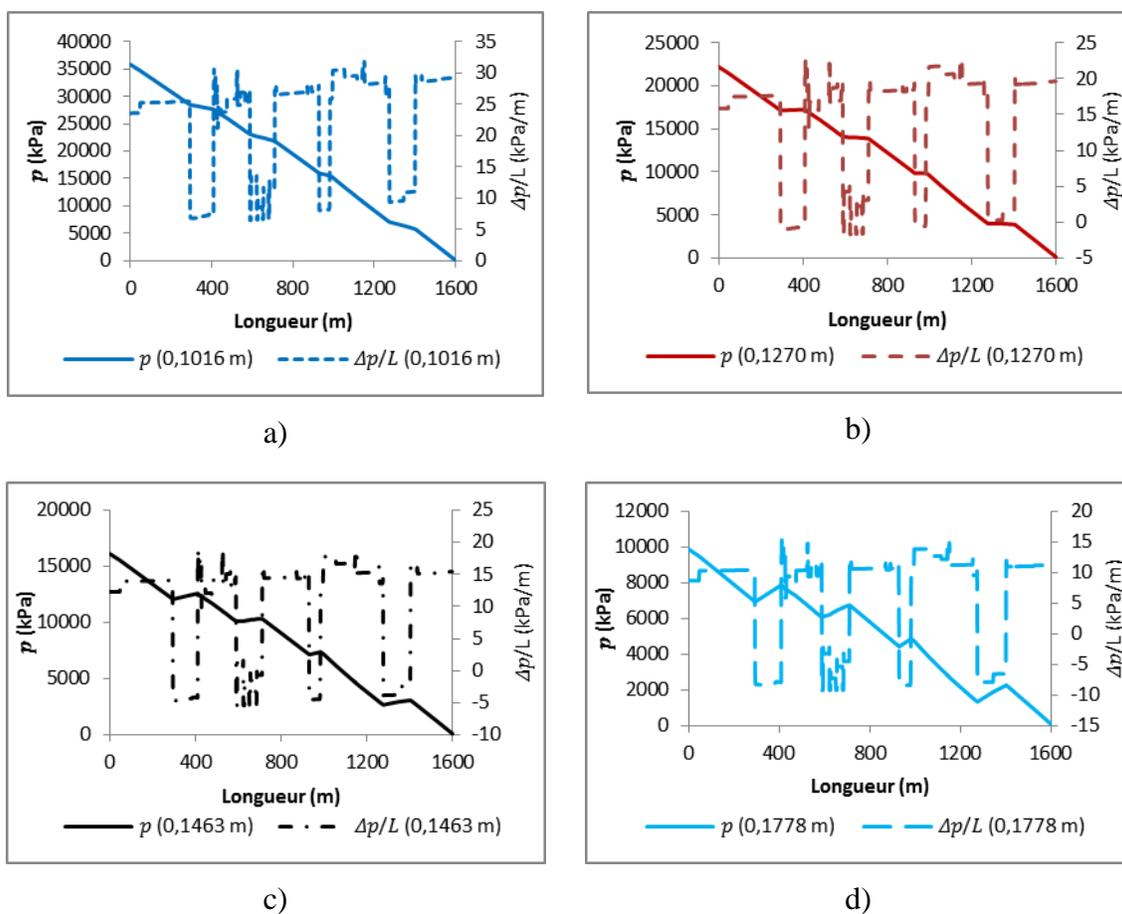
Figure 4.84 : Pressions et pertes de charge du RCPS ( $C_w = 76,3\%$ ) en écoulement à la vitesse de 1,5 m/s dans le réseau de distribution de diamètres internes de 0,1016 m (a), 0,1270 m (b), 0,1463 m (c) et 0,1778 m pour une température souterraine externe de  $-5^{\circ}\text{C}$ .
