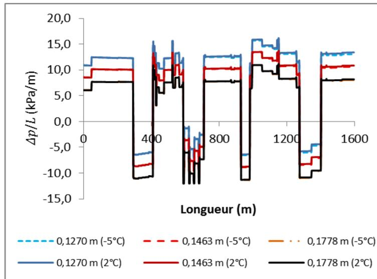
Figure 4.73 : Pertes de charge du RCPS ( $C_w = 76,3\%$ ) en écoulement à une vitesse de 0,82 m/s dans le réseau de distribution de 0,1270 m, 0,1463 m et 0,1778 m de diamètres internes pour des températures externes souterraines de  $-5^\circ\text{C}$  et  $2^\circ\text{C}$ .
