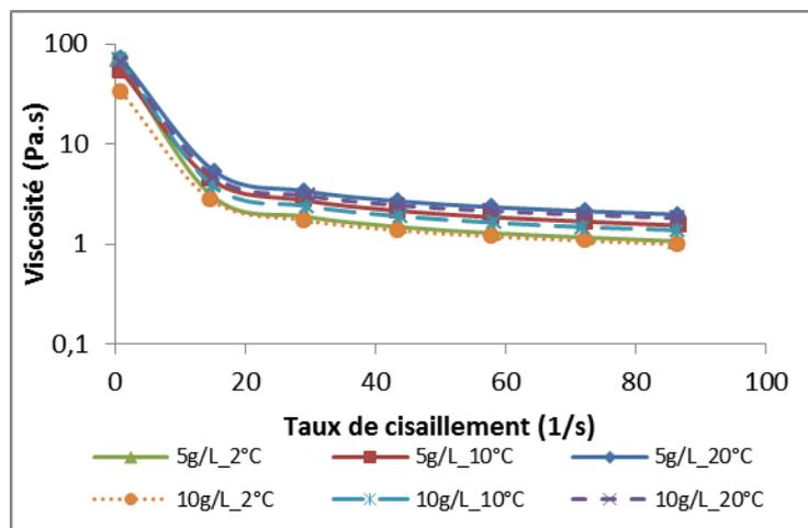
Figure 4.23 : Courbes de la viscosité dynamique mélanges RCPS Goldex (avec  $C_w = 76,3\%$ ;  $B_w = 5\% GU$ ) de 5 et 10 g/L de concentration en sel à 2, 10 et 20°C.
