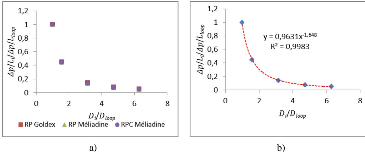
Figure 5.1 : a) Relations entre le ratio de diamètres  $D_i/D_{loop}$  et le ratio de pertes de charge linéaires  $\Delta p/L_i / \Delta p/L_{loop}$ ; b) Équation de l'effet d'échelle établie pour le circuit du mini-essai d'écoulement en boucle
