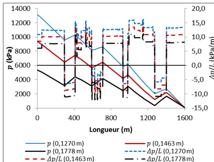
Figure 4.74 : Pressions et pertes de charge du RCPS ( $C_w = 76,3\%$ ) en écoulement à une vitesse de 0,82 m/s dans le réseau de distribution de 0,1270 m, 0,1463 m et 0,1778 m de diamètres internes à la température externe souterraine de  $2^\circ\text{C}$ .
