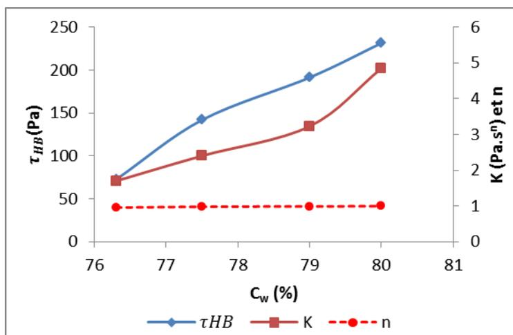
Figure 4.21 : Variation des propriétés rhéologiques du remblai cimenté en pâte (le seuil de cisaillement  $\tau_{HB}$ , l'indice de consistance  $K$  et l'indice d'écoulement  $n$ ) en fonction du pourcentage solide  $C_w$ .
