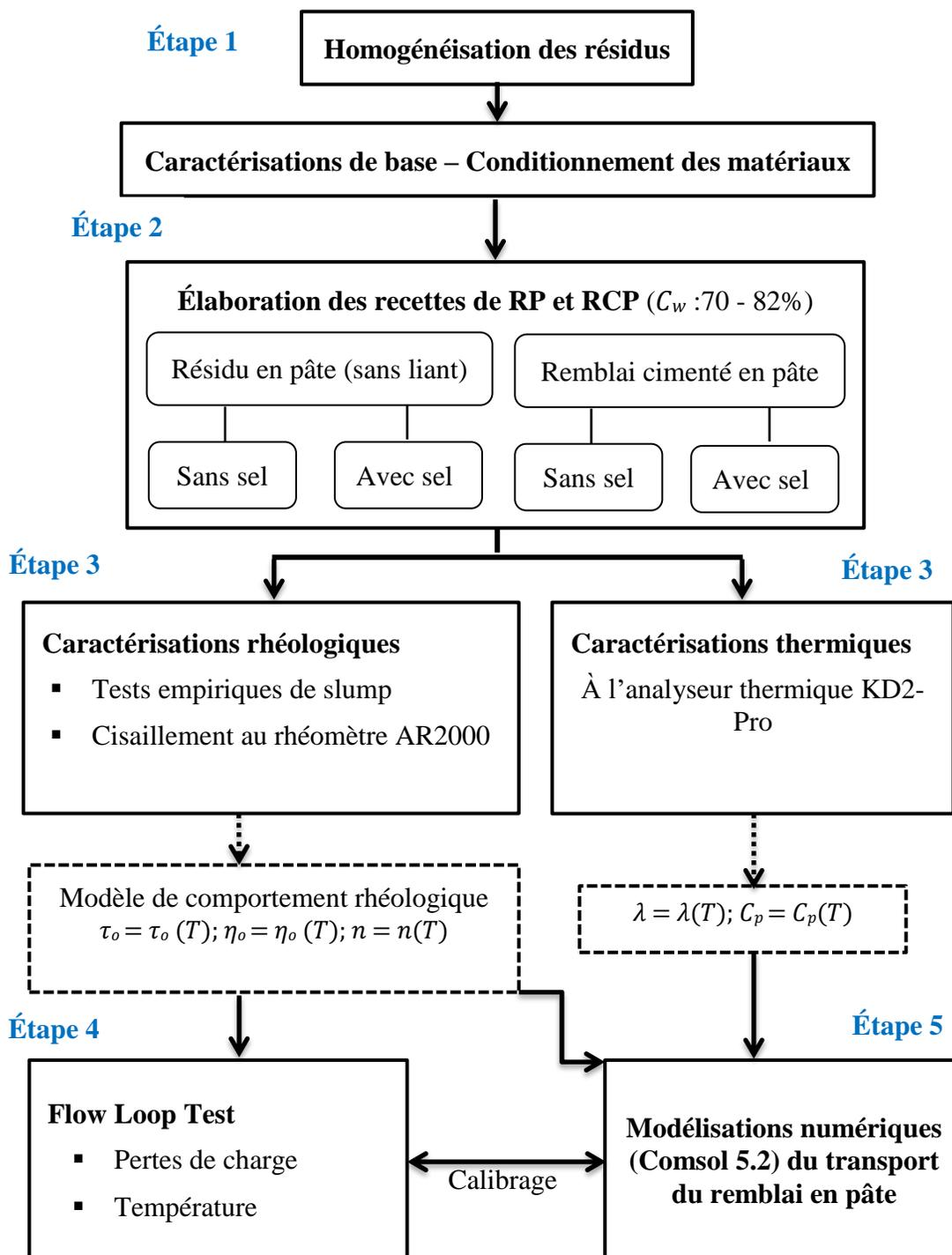
Figure 3.1 : Schéma descriptif de la méthodologie générale
