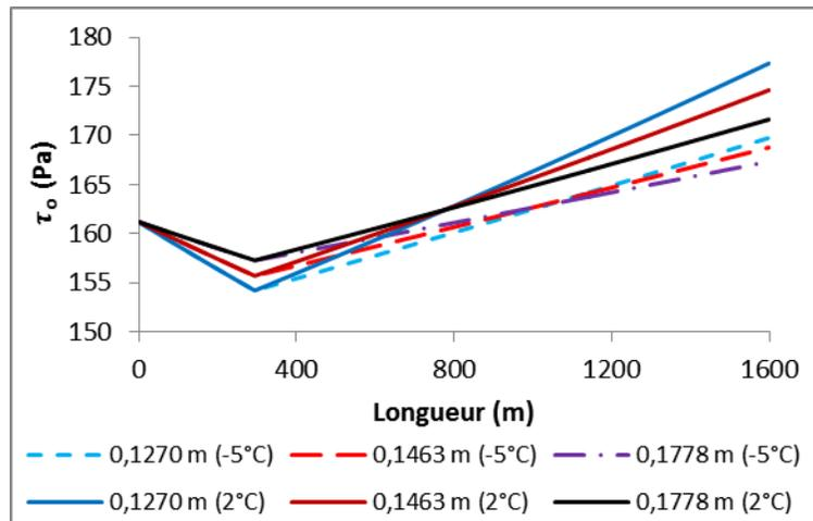
Figure N. 2 : Variations  $\tau_o$  du RCPS en écoulement à la vitesse de 0,82 m/s dans le réseau de distribution de diamètres internes de 0,1270 m , 0,1463 m et 0,1778 m à des températures extérieures souterraines de -5°C et 2°C.
