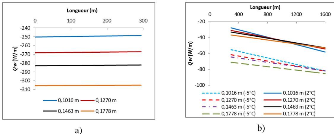
Figure 4.80 : Flux de chaleur à la paroi sur la section à la surface (a) et les sections souterraines (b) du réseau de distribution du RCPS ( $C_w = 76,3\%$ ) à la vitesse d'écoulement de  $1,2\text{ m/s}$ .
