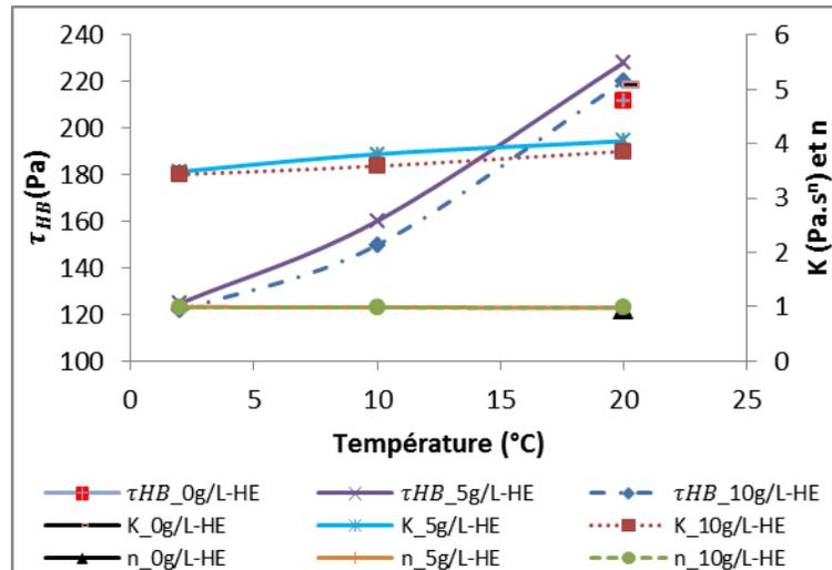
Figure 4.40 : Variation des propriétés rhéologiques de RCPS Meliadine ( $C_w = 76,3\%$  et  $B_w = 5\%$  HE, concentration en sel de 5 et 10 g/L) avec la température.
