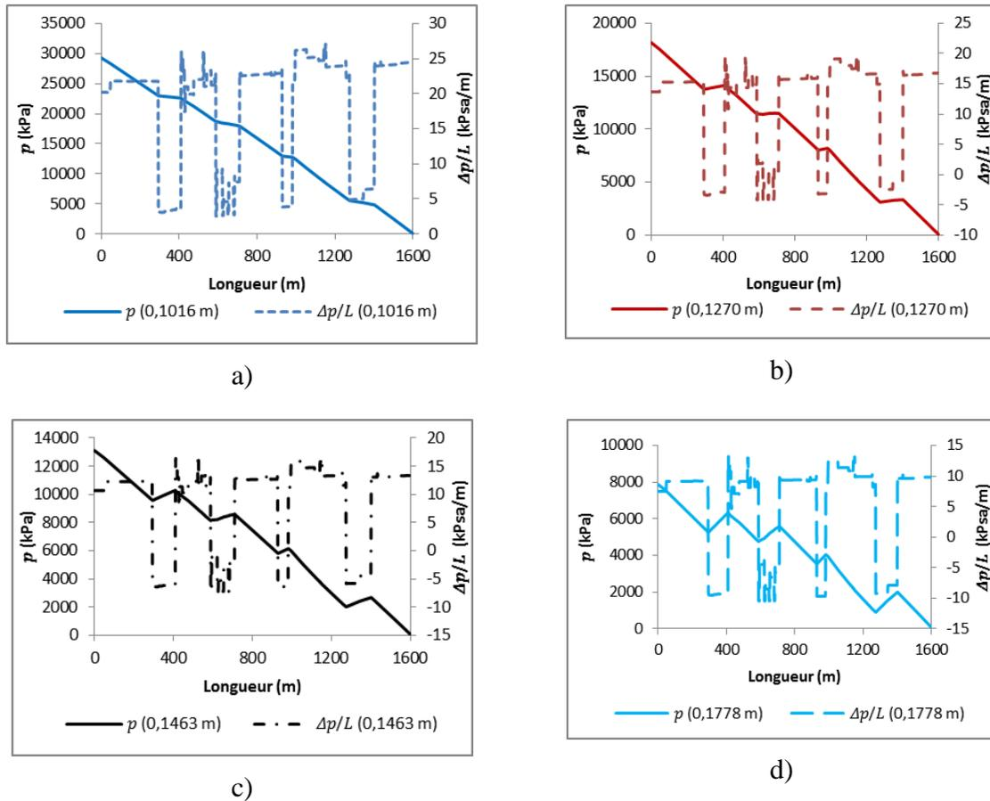
Figure 4.81 : Pressions et pertes de charge du RCPS ( $C_w = 76,3\%$ ) en écoulement à la vitesse de 1,2 m/s dans le réseau de distribution de diamètres internes de 0,1016 m (a), 0,1270 m (b), 0,1463 m (c) et 0,1778 m (d) pour une température souterraine externe de  $-5^\circ\text{C}$ .
