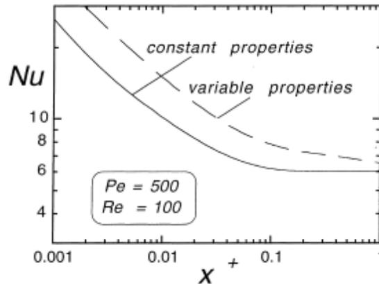
Figure 2.18 : Effet de la variation des propriétés rhéologiques d'un fluide non-newtonien sur le nombre de Nusselt (flux de chaleur constant),  $X^+$  est l'inverse du nombre de Graetz (éq. (2-84) tirée de Soares et al. (1999)
