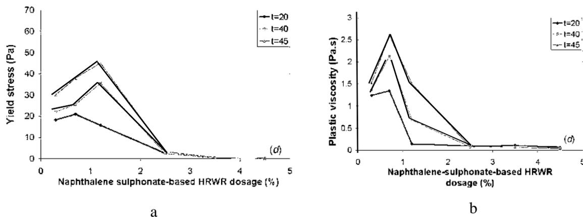
Figure 2.12 : Seuil de cisaillement (a) et viscosité plastique (b) de la pâte de ciment ( $E/C = 0,35$ ) à 20°C, 40°C et 45°C et différents dosages au sulfonate de naphthalène (Al-Martini et Nedhi, 2007)
