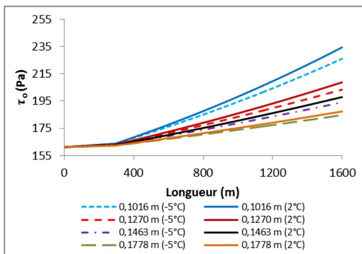
Figure Q. 4 : Variations  $\tau_o$  du RCPS en écoulement à la vitesse de 1,5 m/s dans le réseau de distribution de diamètres internes de 0,1016 m , 0,1270 m , 0,1463 m et 0,1778 m à des températures extérieures souterraines de  $-5^{\circ}\text{C}$  et  $2^{\circ}\text{C}$ .
