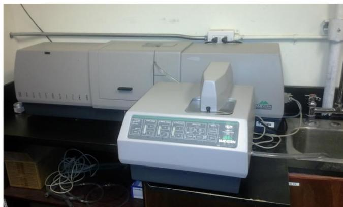
Figure 3.2 : Granulomètre à diffraction laser Mastersize 2000 utilisé
