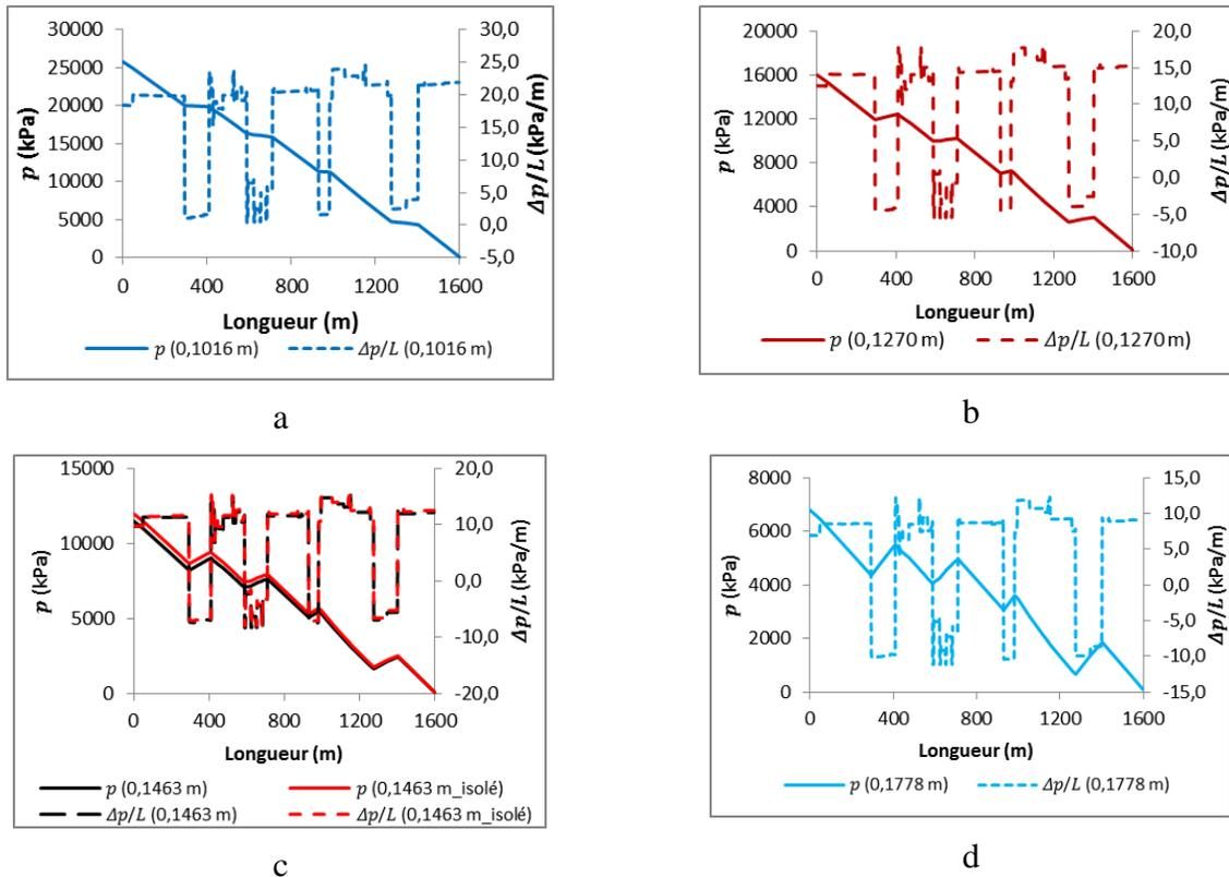
Figure 4.78 : Pressions et pertes de charge du RCPS ( $C_w = 76,3\%$ ) en écoulement à la vitesse de 1,04 m/s dans le réseau de distribution de diamètres internes de 0,1016 m (a), 0,1270 m (b), 0,1463 m (c) et 0,1778 m (d) pour une température souterraine externe de  $-5^\circ\text{C}$ .
