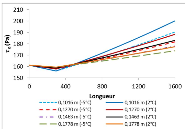
Figure O. 4 : Variations  $\tau_0$  du RCPS en écoulement à la vitesse de 1,04 m/s dans le réseau de distribution de diamètres internes de 0,1016 m, 0,1270 m , 0,1463 m et 0,1778 m à des températures extérieures souterraines de  $-5^{\circ}\text{C}$  et  $2^{\circ}\text{C}$ .
