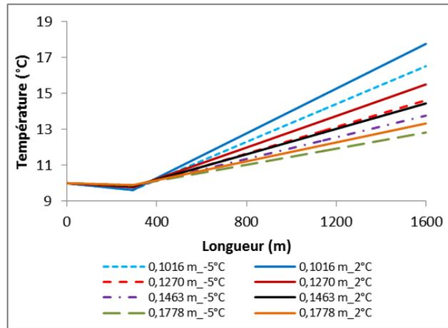
Figure 4.79 : Évolution de la température du RCPS ( $C_w = 76,3\%$ ) en écoulement à une vitesse de  $1,2\text{ m}$  dans le réseau de distribution de  $0,1270\text{ m}$ ,  $0,1463\text{ m}$  et  $0,1778\text{ m}$  de diamètres internes pour des températures externes souterraines de  $-5^{\circ}\text{C}$  et  $2^{\circ}\text{C}$ .
