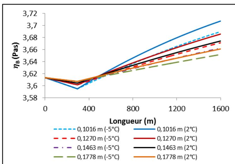
Figure O. 5 : Variations  $\eta_B$  du RCPS en écoulement à la vitesse de 1,04 m/s dans le réseau de distribution de diamètres internes de 0,1016 m, 0,1270 m , 0,1463 m et 0,1778 m à des températures extérieures souterraines de  $-5^{\circ}\text{C}$  et  $2^{\circ}\text{C}$ .
