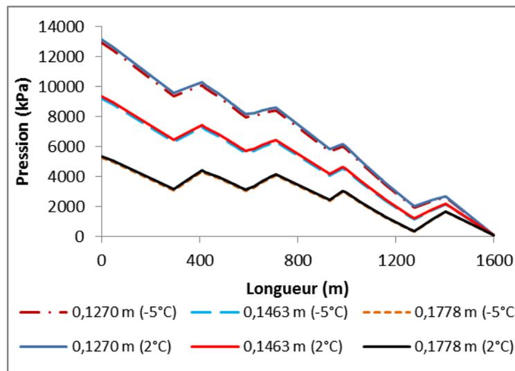
Figure 4.75 : Pressions du RCPS ( $C_w = 76,3\%$ ) en écoulement à une vitesse de  $0,82\text{ m/s}$  dans le réseau de distribution de  $0,1270\text{ m}$ ,  $0,1463\text{ m}$  et  $0,1778\text{ m}$  de diamètres internes et à des températures externes souterraines de  $-5^{\circ}\text{C}$  et  $2^{\circ}\text{C}$ .
