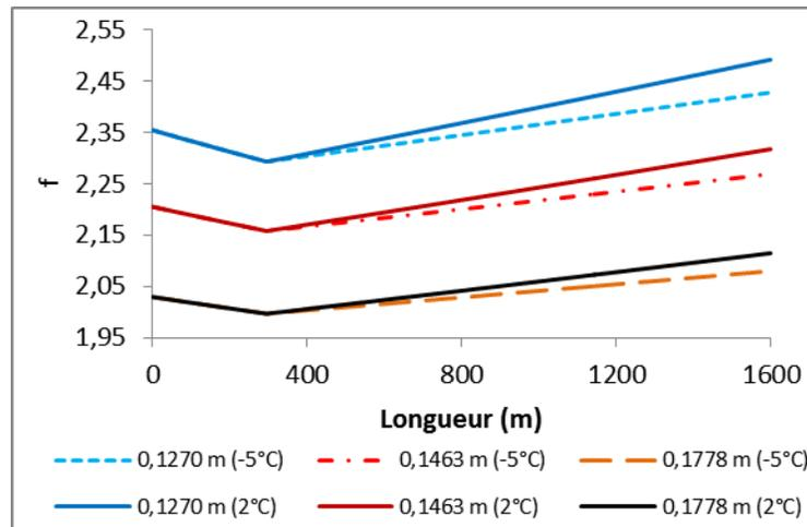
Figure 4.72 : Variations des coefficients de frottement interne du RCPS ( $C_w = 76,3\%$ ) en écoulement à une vitesse de 0,82 m/s dans le réseau de distribution de 0,1270 m, 0,1463 m et 0,1778 m de diamètres internes pour des températures externes souterraines de  $-5^\circ\text{C}$  et  $2^\circ\text{C}$ .
