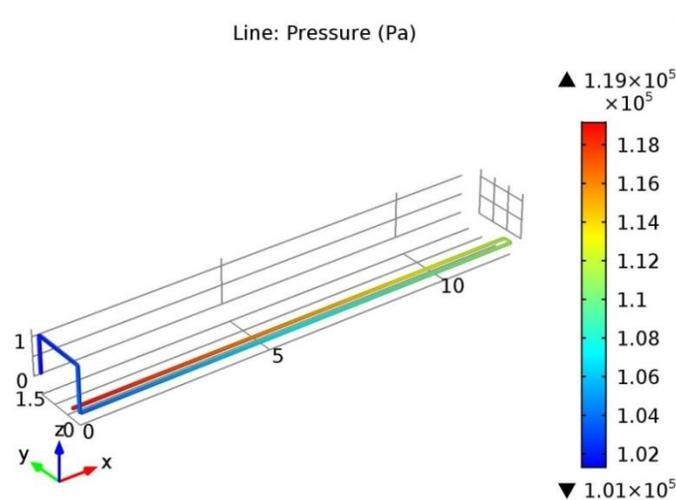
Figure 4.59 : Simulation de la variation de la pression de l'eau en écoulement dans le circuit de l'essai d'écoulement en boucle au cycle de 5 minutes.
