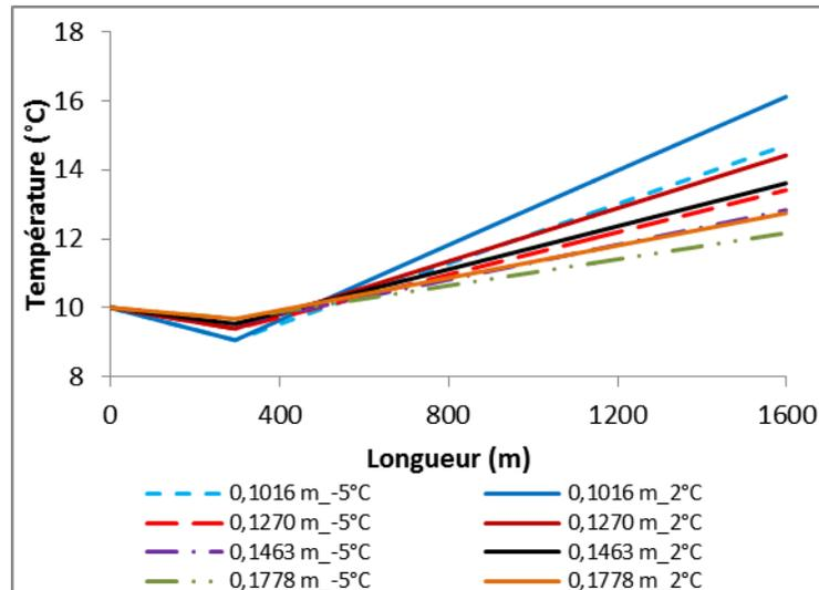
Figure 4.76 : Évolution de la température du RCPS ( $C_w = 76,3\%$ ) en écoulement à une vitesse de  $1,04\text{ m/s}$  dans le réseau de distribution de  $0,1016\text{ m}$ ,  $0,1270\text{ m}$ ,  $0,1463\text{ m}$  et  $0,1778\text{ m}$  pour des températures externes souterraines de  $-5^{\circ}\text{C}$  et  $2^{\circ}\text{C}$ .
