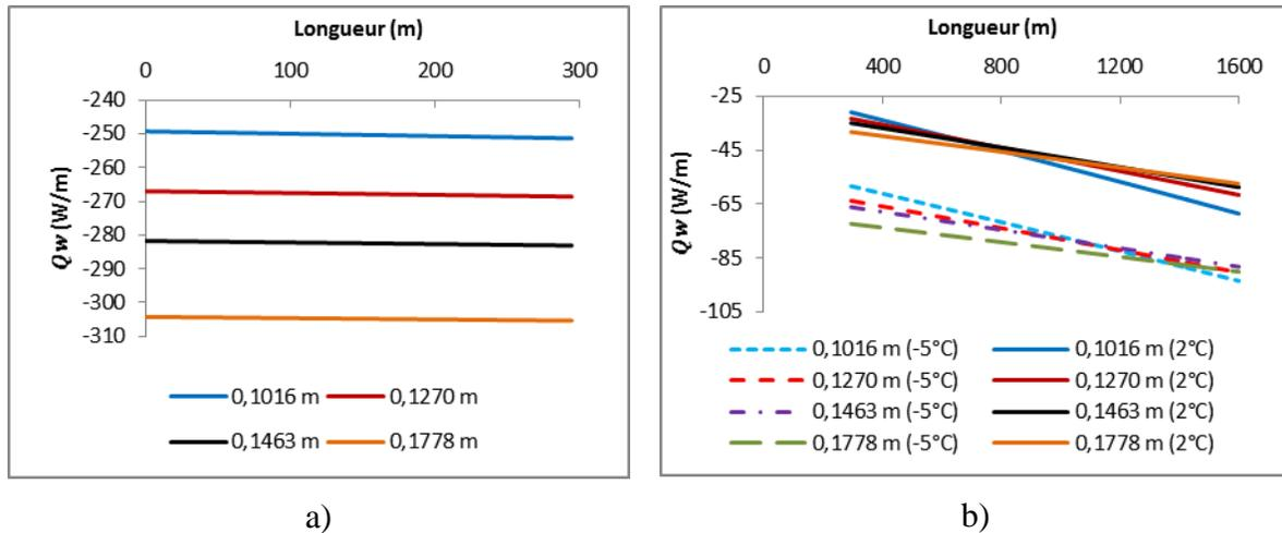
Figure 4.83 : Flux de chaleur à la paroi sur la section à la surface (a) et les sections souterraines (b) du réseau de distribution du RCPS ( $C_w = 76,3\%$ ) à la vitesse d'écoulement de 1,5 m/s.
