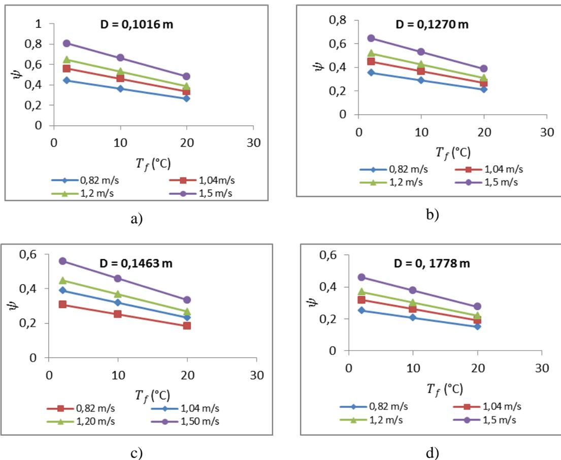
Figure M. 2 : Variation du paramètre  $\psi$  avec la température du RCPS Meliadine ( $C_w = 76,3\%$ ) pour les différents diamètres de pipeline : a.  $D=0,1016 \text{ m}$  ; b.  $D=0,1270 \text{ m}$  ; c.  $D=0,1463$  ; d.  $D=0,1778 \text{ m}$
