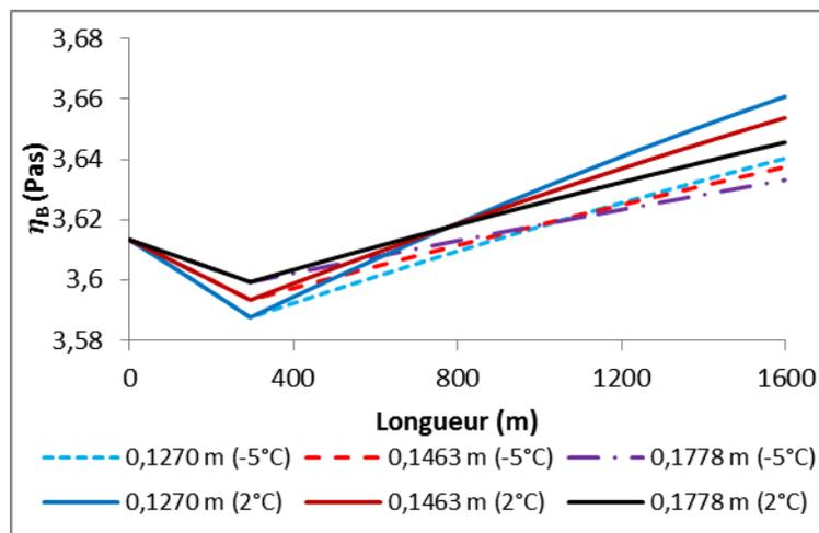
Figure N. 3 : Variations  $\eta_B$  du RCPS en écoulement à la vitesse de 0,82 m/s dans le réseau de distribution de diamètres internes de 0,1270 m , 0,1463 m et 0,1778 m à des températures extérieures souterraines de -5°C et 2°C.
