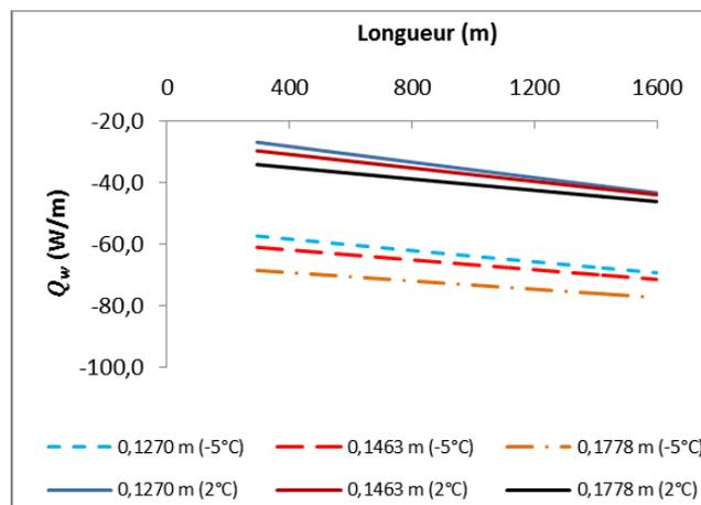
Figure 4.71 : Variations des flux de chaleur à la paroi dans les sections souterraines du réseau de distribution du RCPS ( $C_w = 76,3\%$ ) pour des diamètres internes de  $0,1270 \text{ m}$ ,  $0,1463 \text{ m}$  et  $0,1778 \text{ m}$  de diamètres internes et des températures extérieures de  $-5^\circ\text{C}$  et  $2^\circ\text{C}$ .
