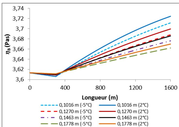
Figure P. 5 : Variations  $\eta_B$  du RCPS en écoulement à la vitesse de 1,2 m/s dans le réseau de distribution de diamètres internes de 0,1016 m , 0,1270 m , 0,1463 m et 0,1778 m à des températures extérieures souterraines de  $-5^{\circ}\text{C}$  et  $2^{\circ}\text{C}$ .
