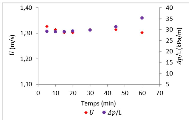
Figure 4.56 : Variation de la vitesse d'écoulement et de la perte de charge du RCP Meliadine ( $C_w = 71\%$  et  $B_w = 5\%HE$ ) avec le temps d'écoulement dans le circuit du mini-essai d'écoulement en boucle.
