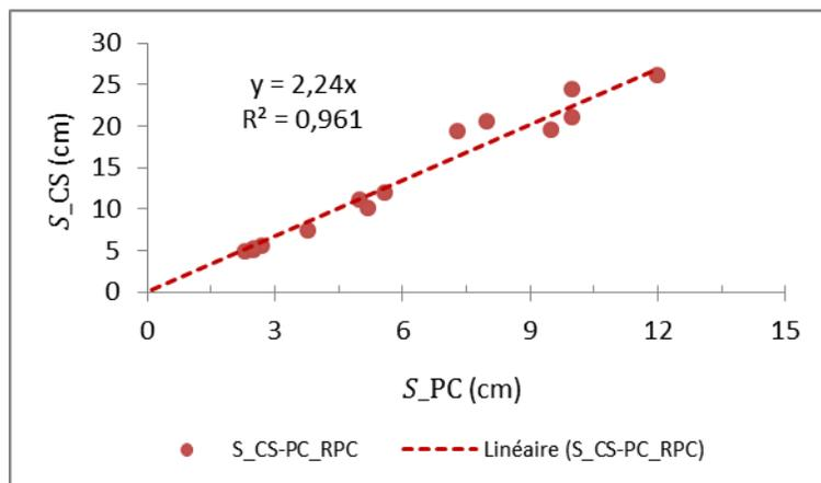
Figure 4.10 : Relation généralisée entre l'affaissement au cône standard CS et l'affaissement PC du remblai en pâte Goldex
