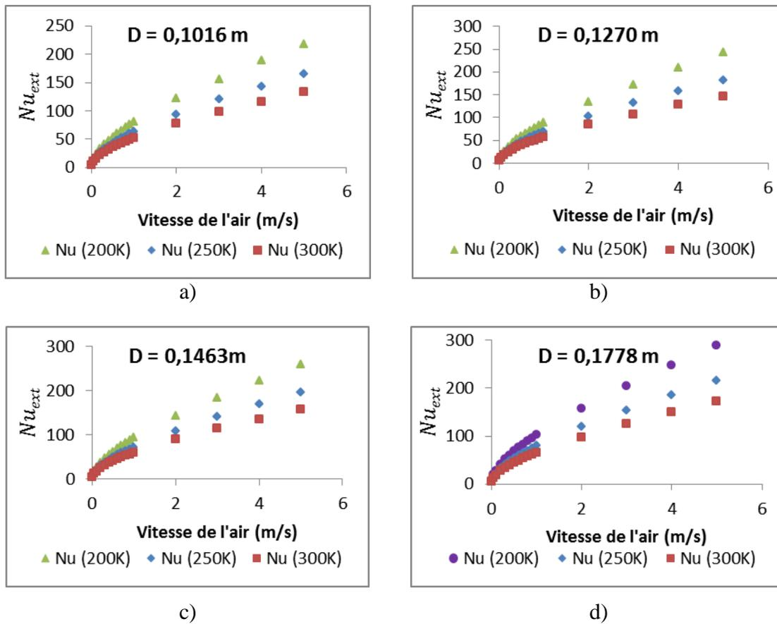
Figure M. 1 : Variation du  $Nu_{ext}$  avec la vitesse et la température de l'air pour les différents diamètres de pipeline de 2,5 cm d'épaisseur : a.  $D=0,1016$  m ; b.  $D=0,1270$  m ; c.  $D=0,1463$  ; d.  $D=0,1778$  m
