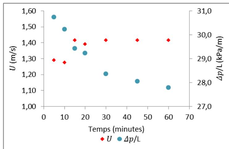
Figure 4.53 : Variation de la vitesse d'écoulement  $U$  et de la perte de charge linéaire  $\Delta p/L$  du RP Meliadine ( $C_w = 71\%$ ) avec le temps d'écoulement dans le circuit du mini loop test.
