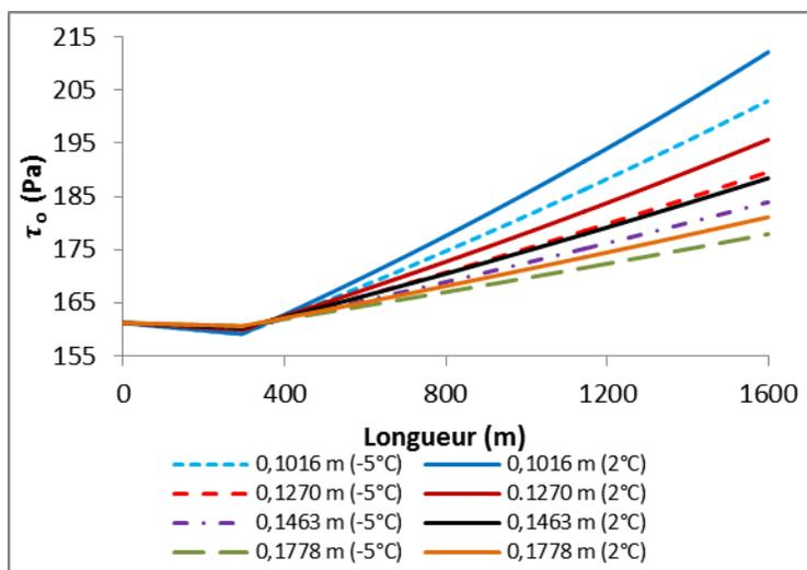
Figure P. 4 : Variations  $\tau_o$  du RCPS en écoulement à la vitesse de 1,2 m/s dans le réseau de distribution de diamètres internes de 0,1016 m , 0,1270 m , 0,1463 m et 0,1778 m à des températures extérieures souterraines de  $-5^{\circ}\text{C}$  et  $2^{\circ}\text{C}$ .
