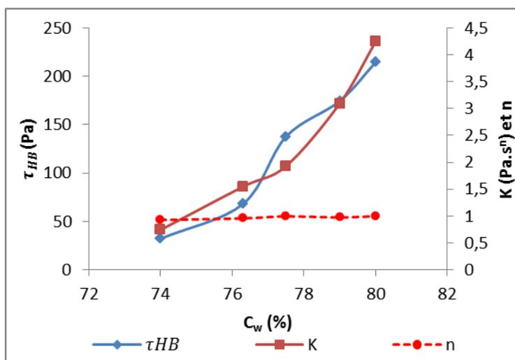
Figure 4.15 : Variation des propriétés rhéologiques du résidu en pâte (le seuil de cisaillement  $\tau_{HB}$ , l'indice de consistance  $K$  et l'indice d'écoulement  $n$ ) en fonction du pourcentage solide  $C_w$ .
