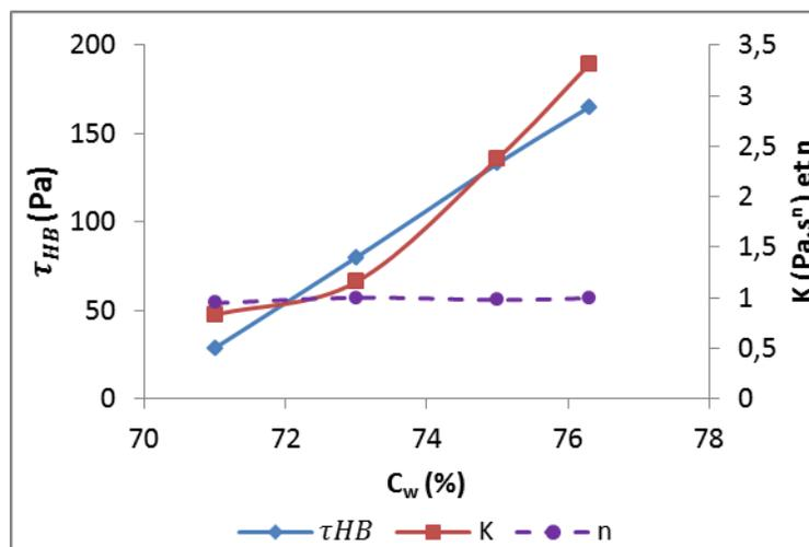
Figure 4.18 : Variation des propriétés rhéologiques du résidu en pâte Meliadine (le seuil de cisaillement  $\tau_{HB}$ , l'indice de consistance  $K$  et l'indice d'écoulement  $n$ ) en fonction du pourcentage solide  $C_w$  à  $20^\circ\text{C}$ .
