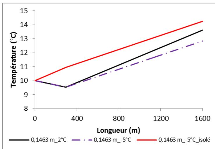
Figure 5.6 : Effet de l'isolation de la section à la surface sur la température du RCPS ( $C_w=76,3\%$ ) en écoulement dans le réseau de distribution de 0,1463 m de diamètre interne à une vitesse de 1,04 m/s.
