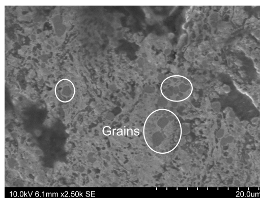
Figure 5.6 Images MEB à 2500X d'une section latérale de (\text{Fe}_3\text{Al})_{30}\text{Ti}_{35}\text{BN}_{35} recuite à 1400^\circ\text{C}
