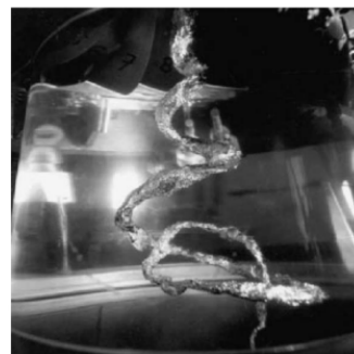
(d) Vortex cavitant en tube
