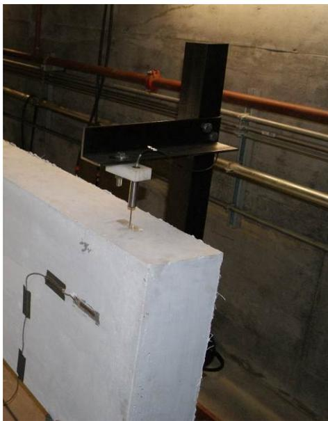
Figure E-9 : Tassement à l'appui
