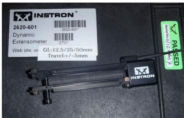
Figure C-11 : Extensomètre
