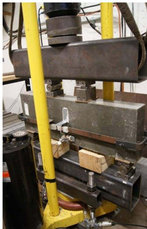
Figure 3.6 : Dispositif de fluage flexionnel
