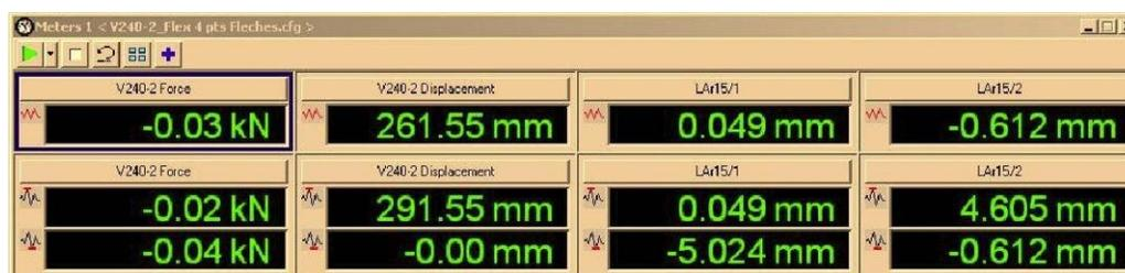
Figure C-16 : Mise à zéro des données de déplacement et des valeurs min-max
