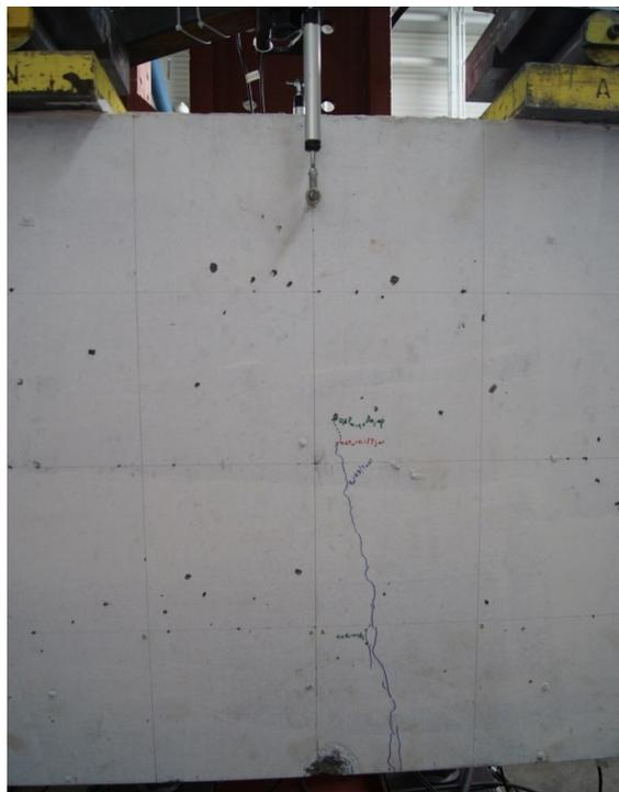
Figure B-28 : Faciès de fissuration
