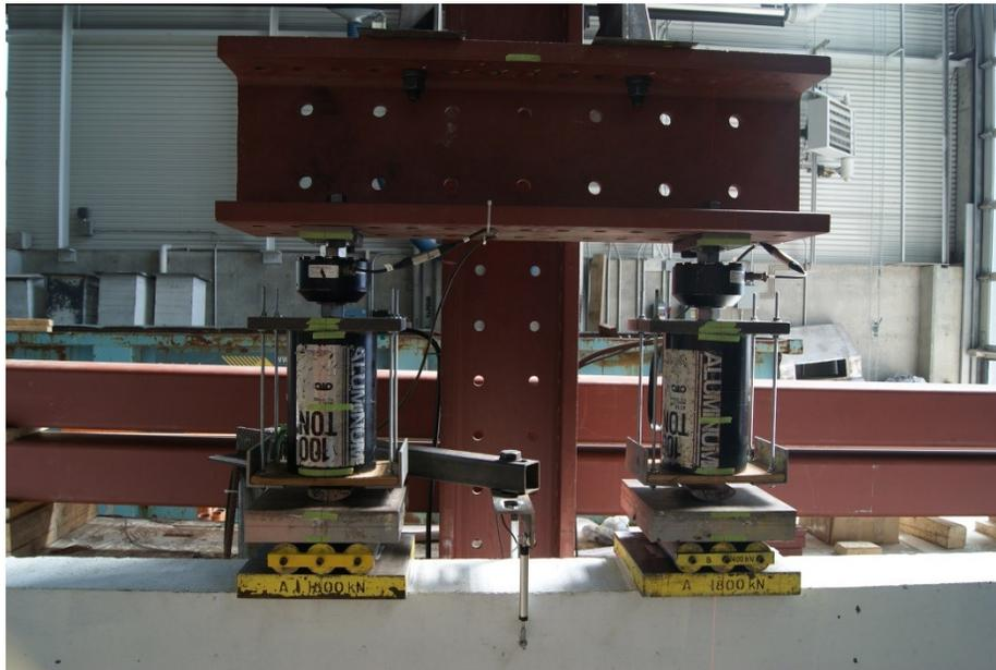
Figure 3.32 : Système de transfert des efforts – poutre de 8 mètres
