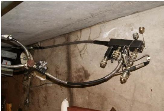
4. Multiplicateur hydraulique et valve hydraulique de contrôle des vérins
