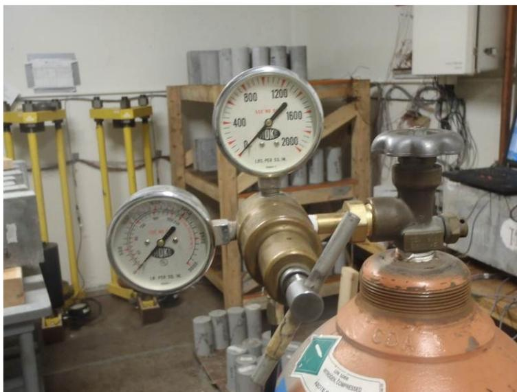
Figure D-15 : Régulateur de pression du cylindre d'azote comprimée
