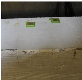
Figure E-5 : Système de mise à niveau des plaques d'appui supérieures
