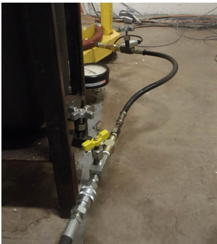
Figure D-17 : De bas en haut, valve VH1 (en jaune), valve de sécurité de l'accumulateur, valve VH2, et capteur de pression hydraulique
