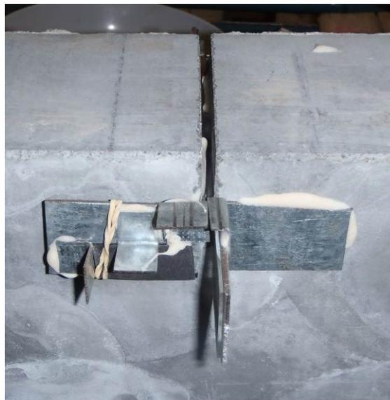
Figure C-12 : Support à extensomètres
