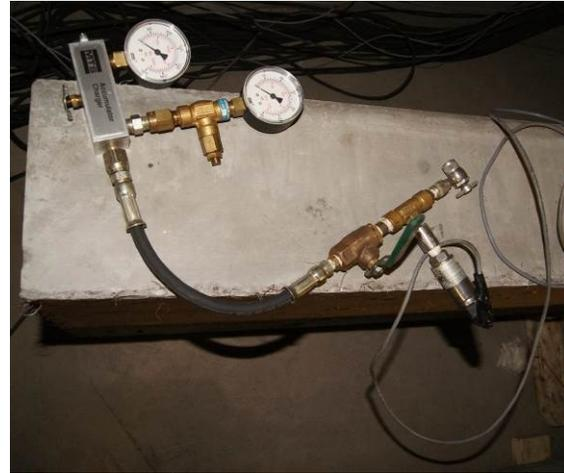
2. Valve de chargement d'azote
