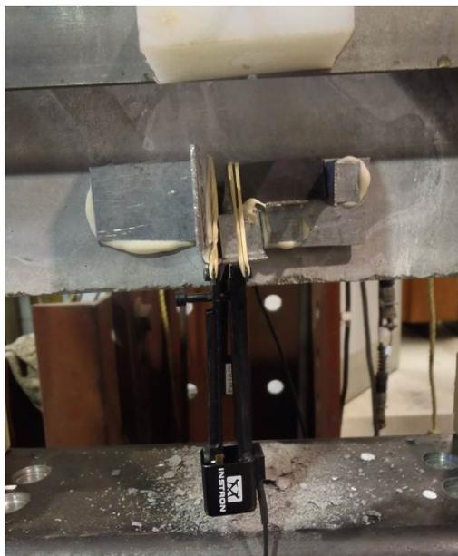
Figure C-13 : Installation d'un extensomètre
