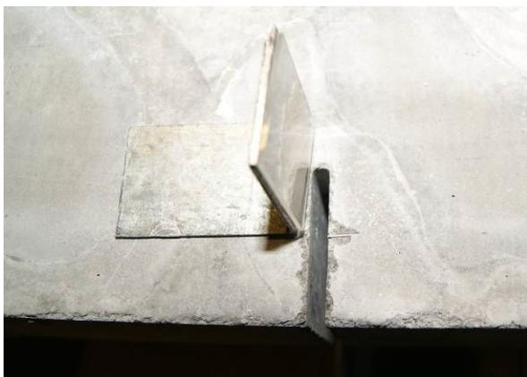
Figure D-5 : Cornière LVDT ouverture de fissure
