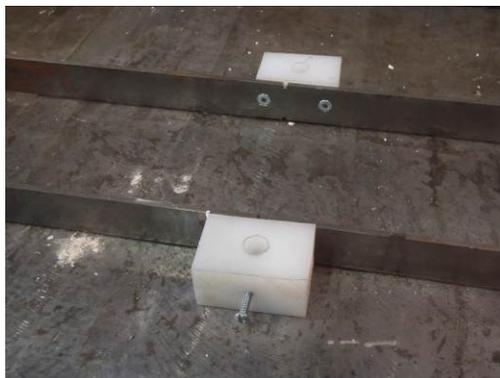
Figure C-9 : Tige d'instrumentation avec supports à LVDTs
