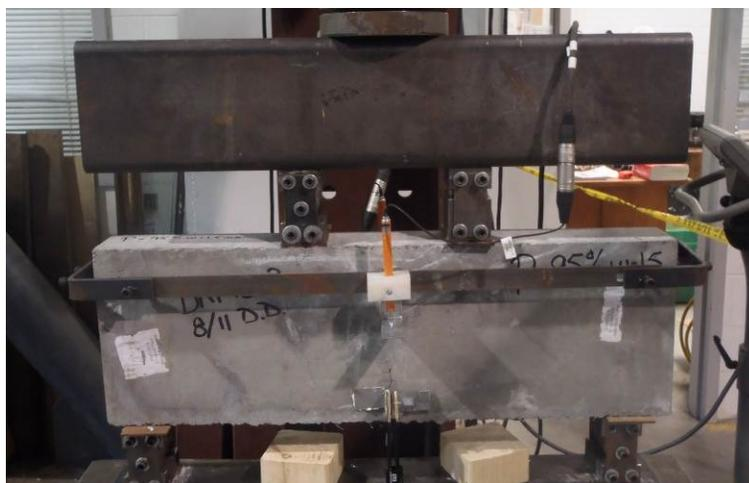
Figure C-10 : Instrumentation des flèches
