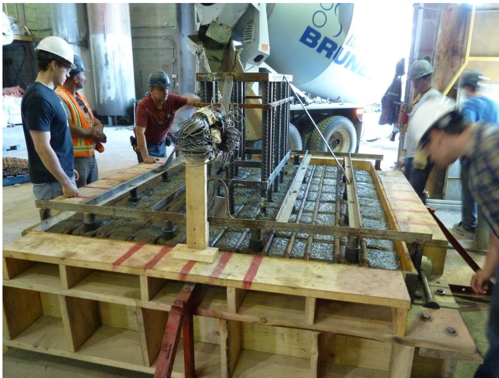
Figure 3.5 : Coulée de la semelle
