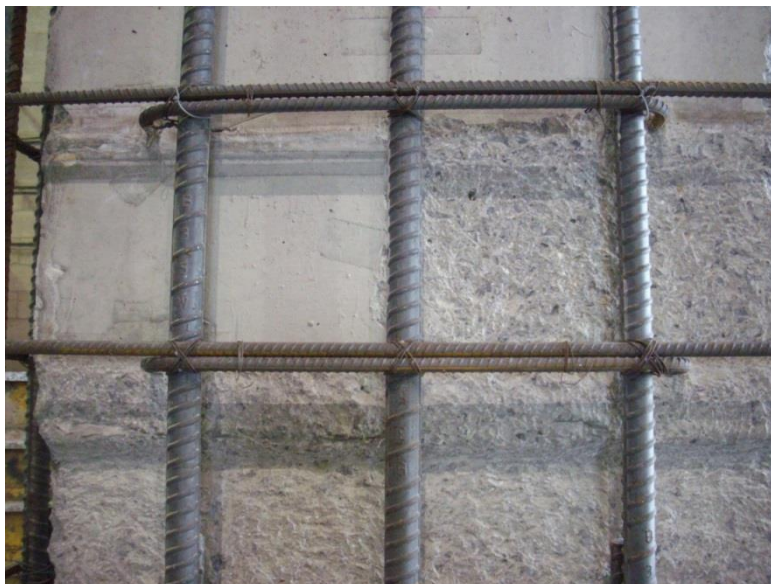
Figure 3.7 : Zone non-martelée (à gauche) vs zone martelée (à droite) – Spécimen S5
