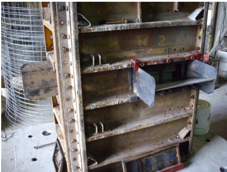
Figure 3.9 : Ouvertures refermables à la mi-hauteur du coffrage permettant de débiter la coulée du BFUP
