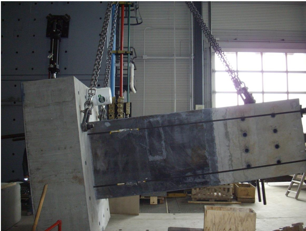
Figure 3.11 : Basculement de la pile
