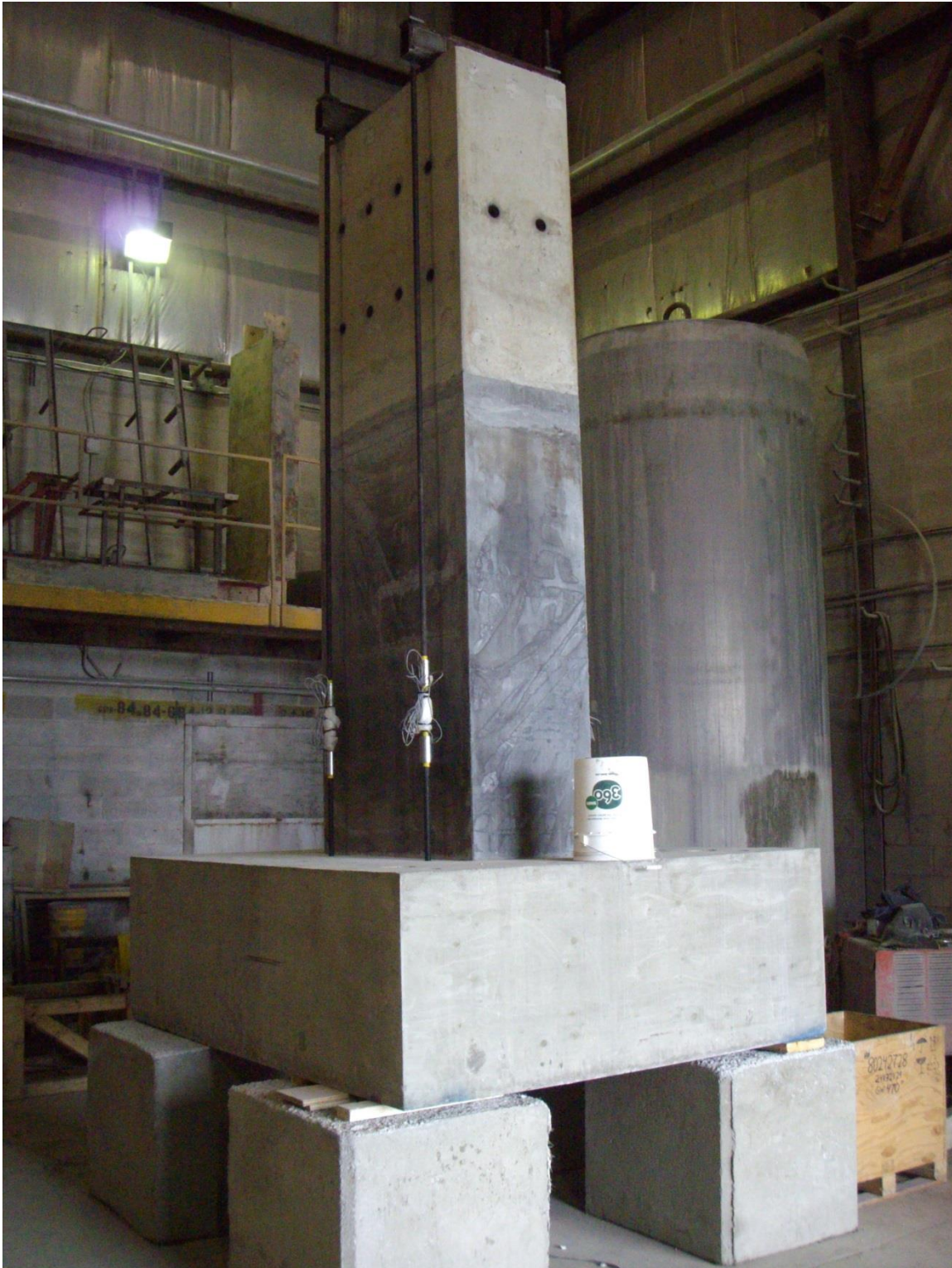
Photo 7 : Post-tension d'environ 400 kN appliquée sur la pile S5 (12 nov.)
