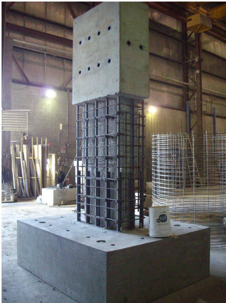
Figure 3.2 : Détails de fabrication de la pile S5
