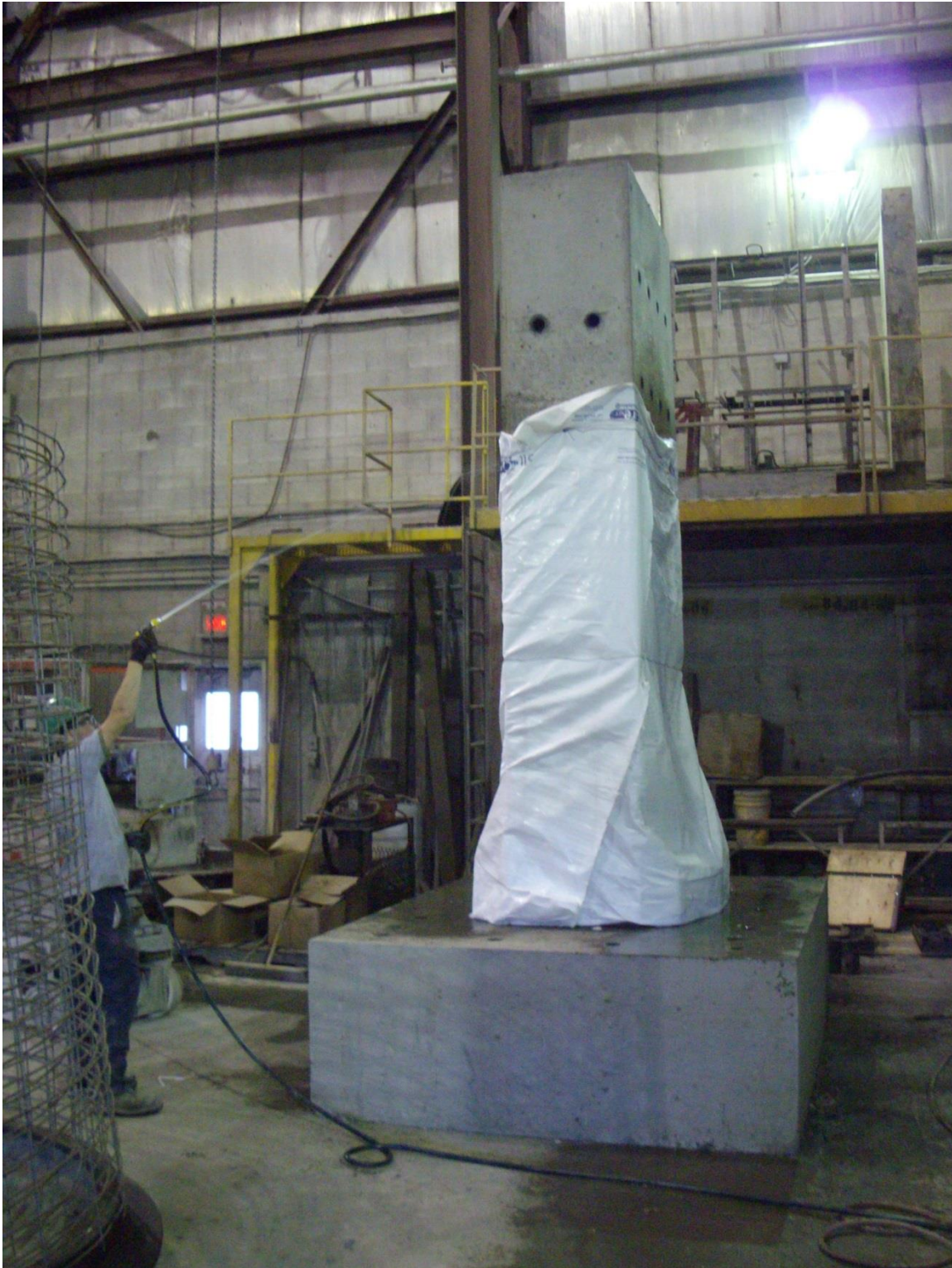
Photo 5 : Cure humide de la pile S5 (25 oct.)
