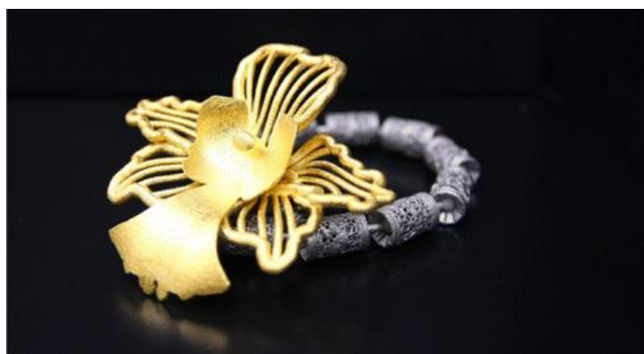
Figure 2-5: Bijoux produit par impression 3D illustrant les nouvelles possibilités (issu de réf [22], produit en titanium par Laser Sistering Machine)
