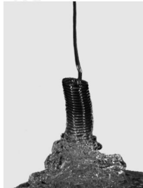
Figure 2-9: illustration de l'effet bouclant de la chute d'un filament visqueux sur une plateforme solide (issu de réf [38])
