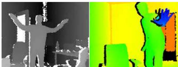
Figure 2.1 Image de profondeur générée par la caméra 3D Kinect de Microsoft
