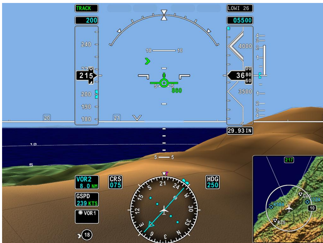
Figure 4.3 Le iPFD de Honeywell intègre l'information de différentes sources à l'écran de façon harmonieuse en effaçant la séparation entre les informations de vol (au premier plan) et le paysage (à l'arrière plan) (Honeywell, 2007).
