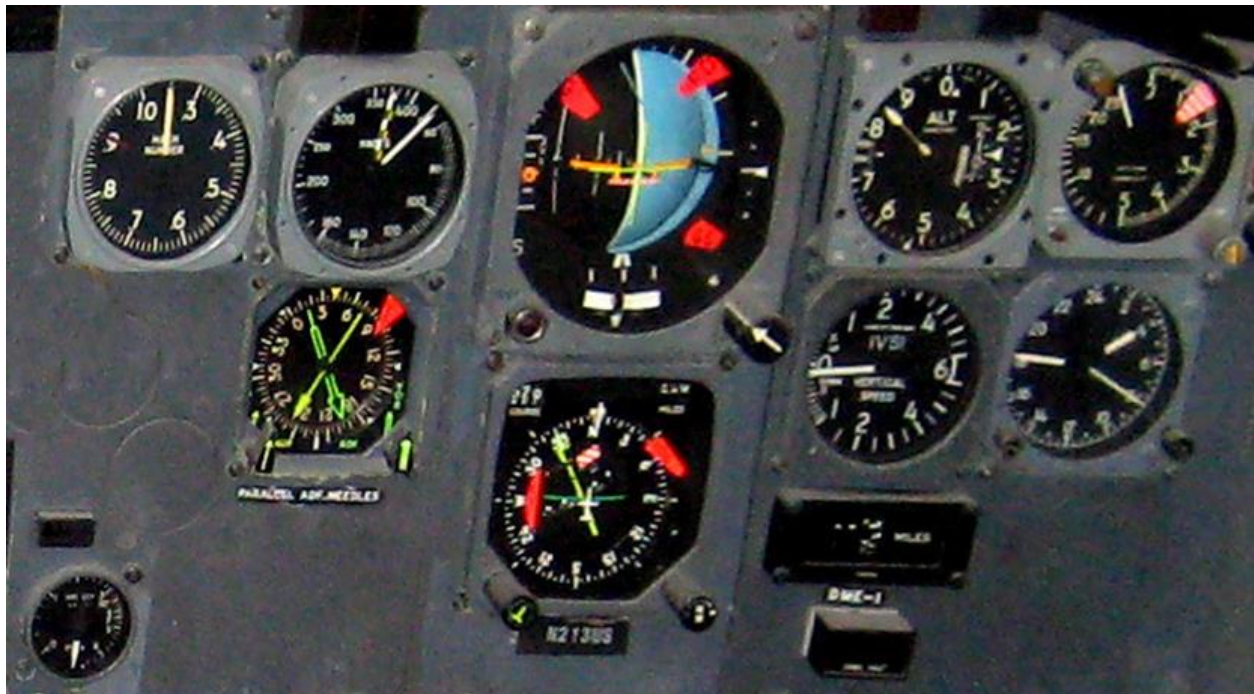
Figure 4.2 Panneau d'instruments du Boeing 737 avec l'horizon artificiel au centre. Image libre de droits par Sol Young (CC-BY-2.0).
