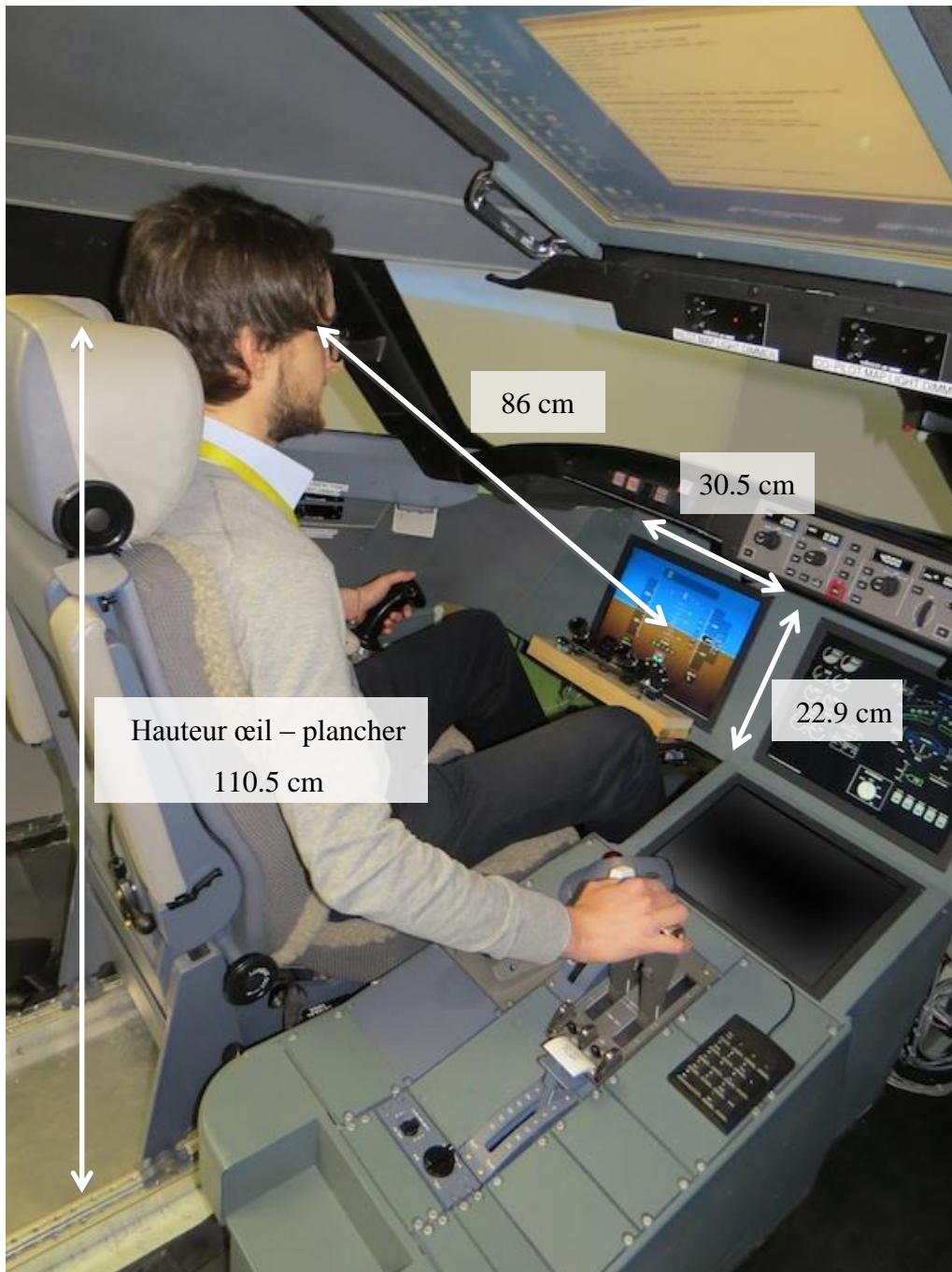
Figure 5.2 Géométrie du poste de pilotage par rapport aux yeux du pilote.
