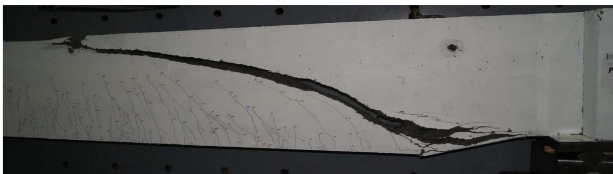
Figure 5-21 : R03 - Fissure principale de cisaillement
