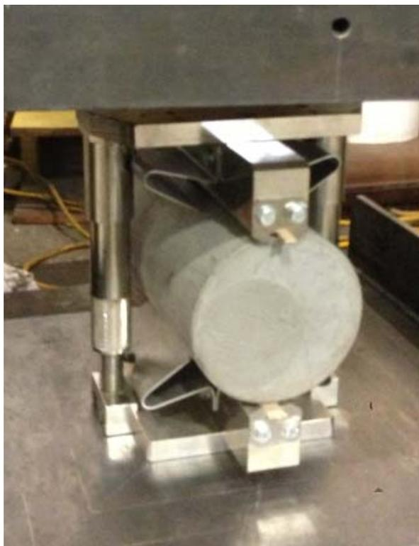
Figure 4-11 : Cylindre en place dans la presse
