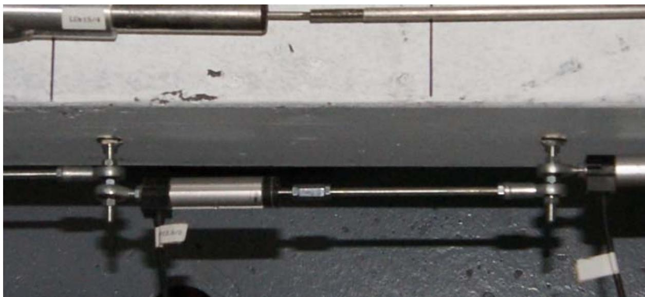
Figure 4-45 : Photographie des extensomètres linéaires
