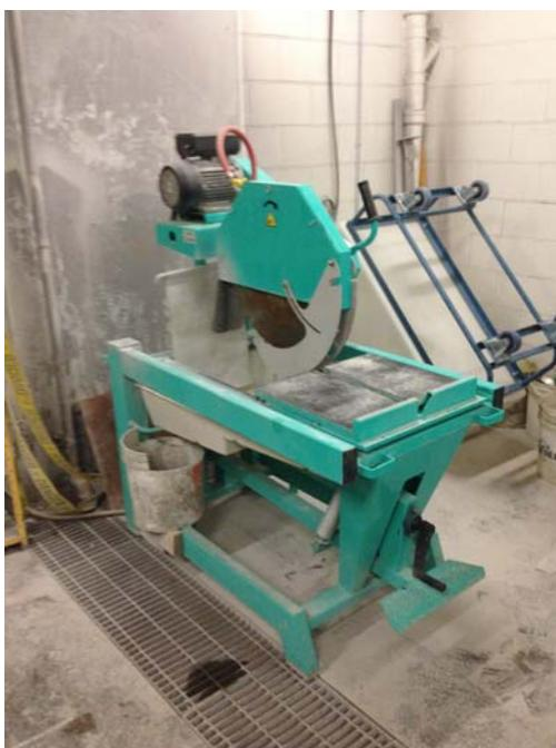
Figure 4-5 : Scie à béton du laboratoire de l'EPM
