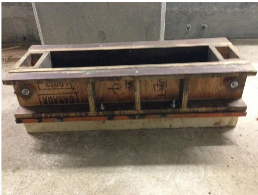
Figure 4-4 : Coffrage de prisme RILEM
