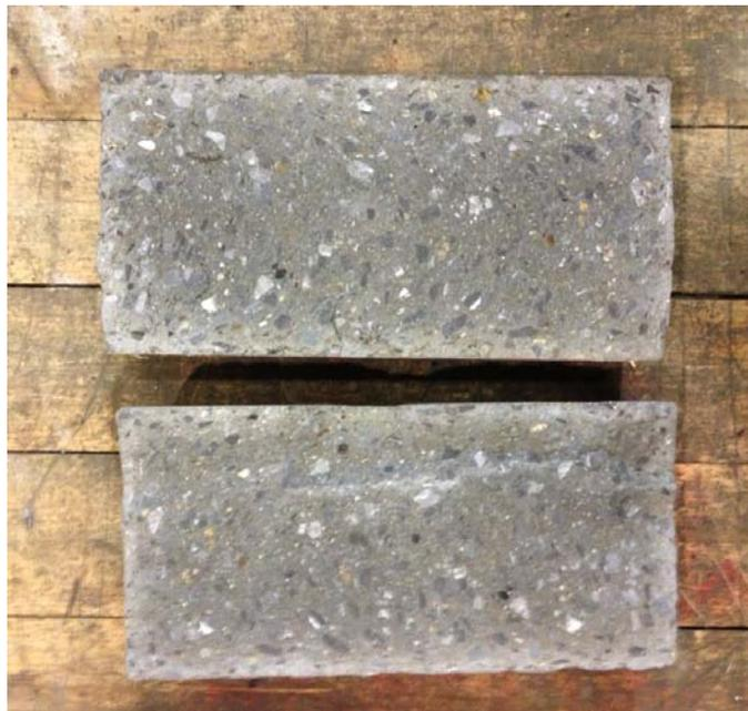
Figure 5-14 : Cylindre 6 pouces après l'essai brésilien - R08
