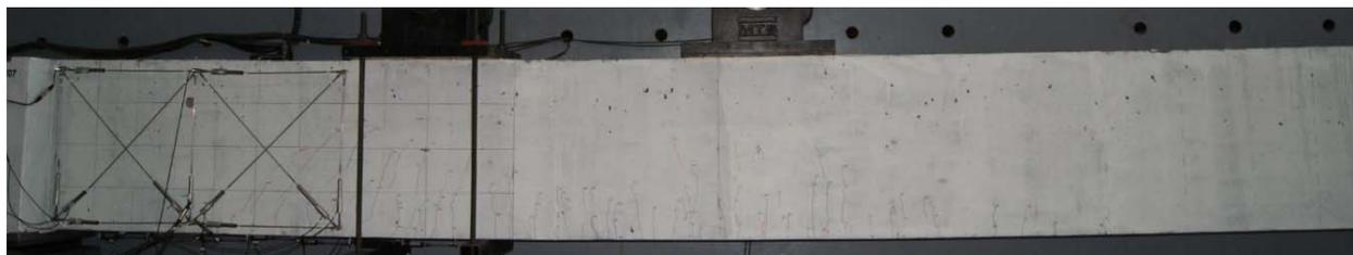
Figure 5-29 : Relevé des fissures de la poutre R07
