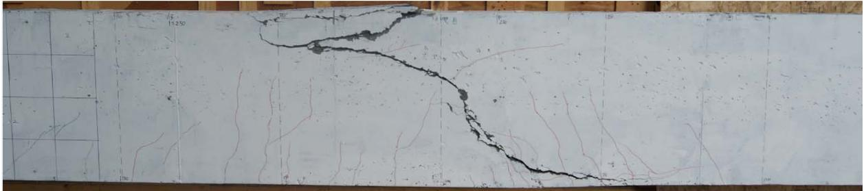
Figure 5-24 : Relevé des fissures de la poutre R06-2
