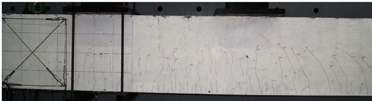
Figure 5-26 : Relevé des fissures de la poutre R06-1
