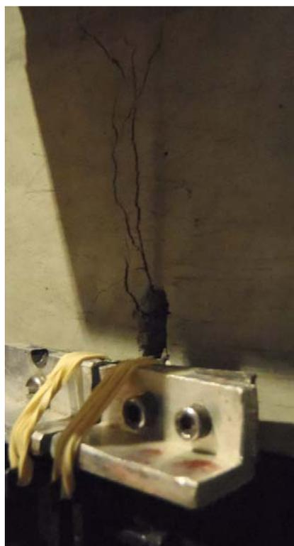
Figure 5-1 : Photographie d'un prisme ayant multi-fissuré
