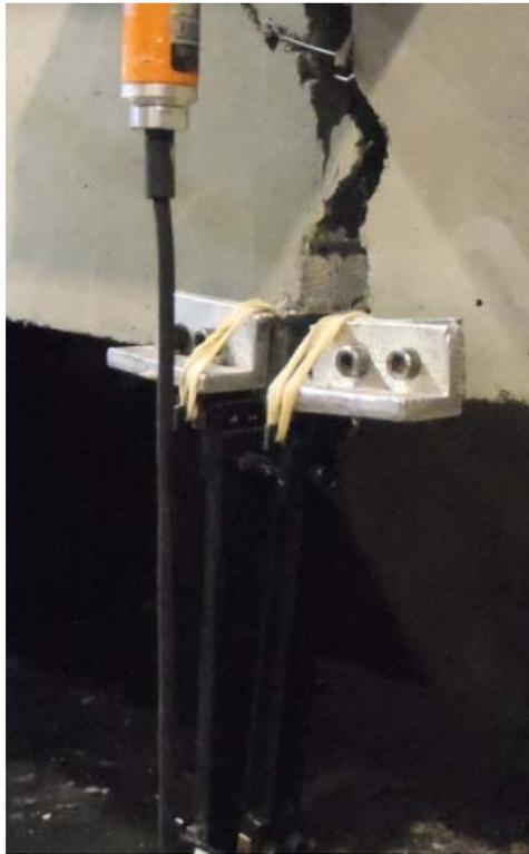
Figure 4-6 : Extensomètre fixé dans la fente du prisme
