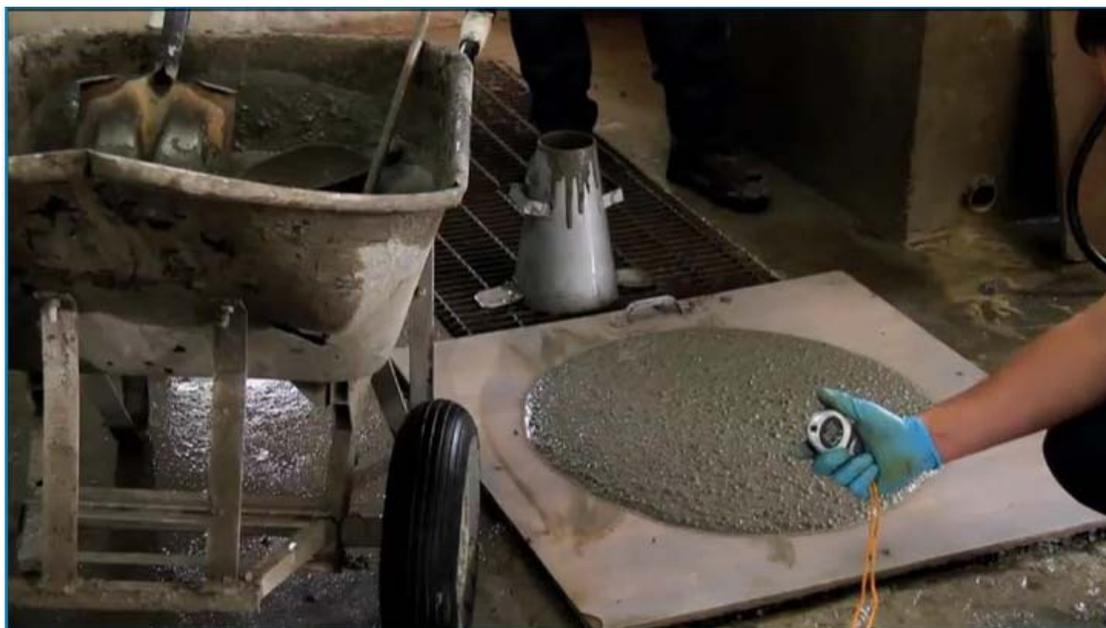
Figure 2-14 : Étalement au cône d'Abrams
