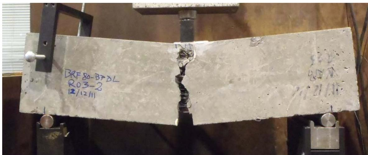
Figure 5-2 : Photographie d'un spécimen ayant fissuré correctement
