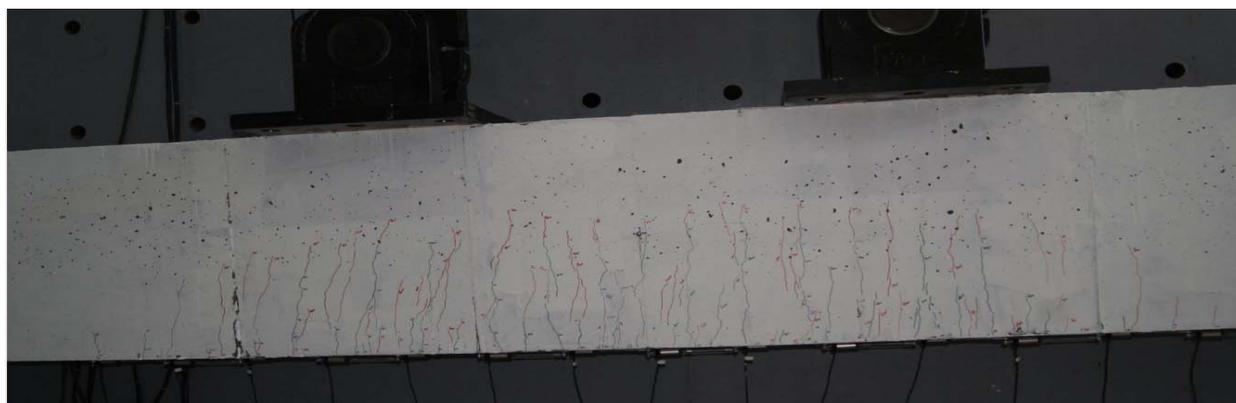
Figure 5-23 : R05 - Vue d'ensemble du relevé des fissures
