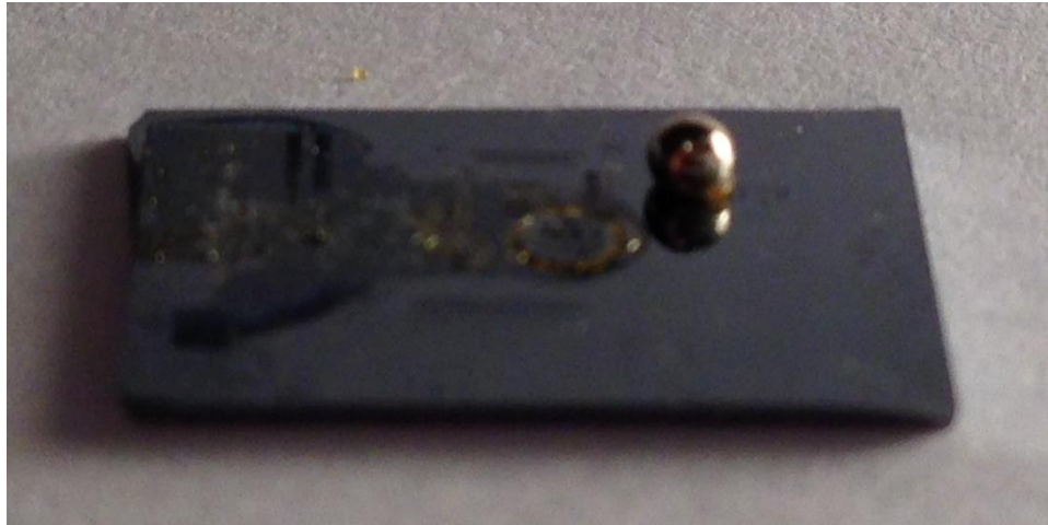
Figure 4-33 : Bille formée par la pâte de soudure AuSn
