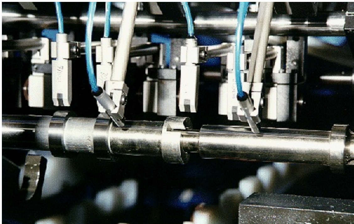
Figure 2.3 Système automatisé d’inspection par courants de Foucault sur un arbre à cames. MAR-POSS (2013).
