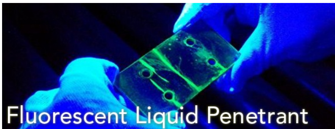
Figure 2.9 Inspection sous un éclairage ultraviolet des traces de pénétrant fluorescent (en vert) après ressuage. Extrait de [1].
