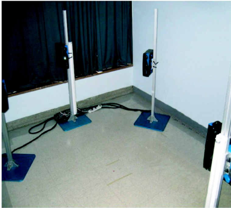
Figure 2.11 Système d'acquisition Inspeck. Quatre caméras selon différentes vues sont utilisées pour générer la topographie de surface du tronc.
