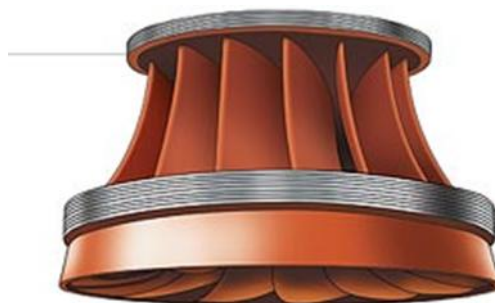
Figure 3: Dessin 3D d'une roue de turbine Francis (source Hydro-Québec)
