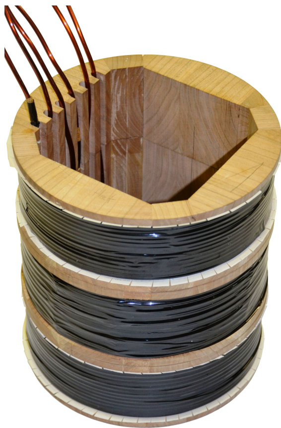
Figure 4.15: Vues des 3 bobines secondaires empilées et emboîtées.
