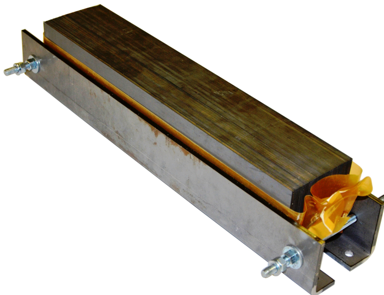
Figure 4.3: Assemblage final des tôles en I.
