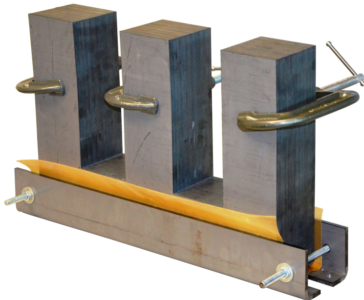
Figure 4.2: Assemblage final des tôles en E maintenues mécaniquement par deux pièces d'acier.
