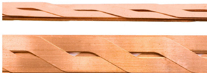
Figure 2.23: Photographie d'un câble Roebel [25].
