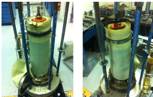
Figure 4.4 : Échantillon de sable au démoulage (gauche) et au démontage (droite) de l'essai SDyn004 - 100
