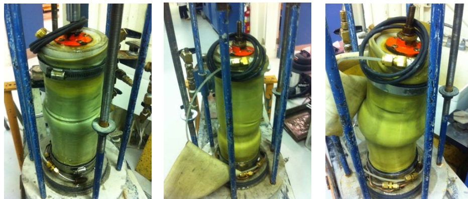
Figure 4. 5 : Photos des échantillons de résidus miniers en fin d'essai (de gauche à droite : RMDyn002 – 100, RMDyn003 – 200, RMDyn004 – 200)
