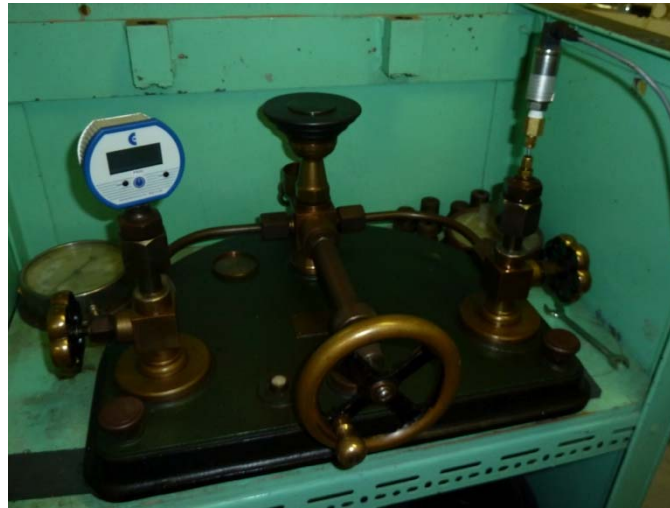
Figure A3.1 : Système de contrôle de pression avec piston de chargement sans friction
