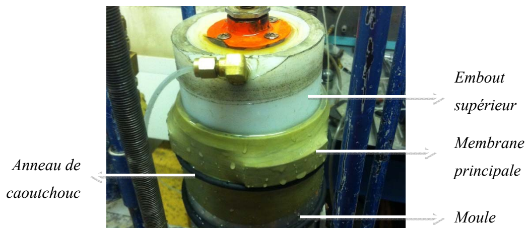
Figure 2. 16 : Mise au jour de la membrane principale et de son système de fixation suite à l'enlèvement de la demi membrane
