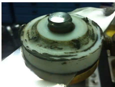
Figure 4.16 : Usure de la fixation inférieure de l'arbre causée par la rotation du système arbre/fixation et les propriétés abrasives des résidus miniers
