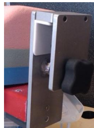
Figure 20: Attache du support du bassin
