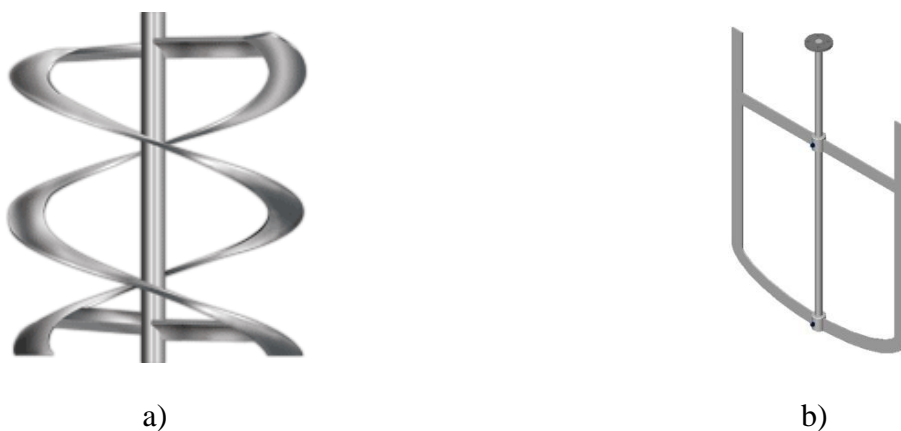
Figure 1.3. Exemple de mobiles raclant: a) Double ruban hélicoïdal 3 , b) ancre 4
