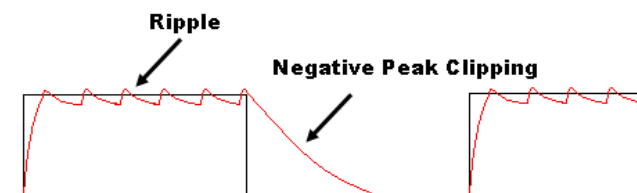
Figure 5-8. Illustration des « Ripples » et du « Negative Peak Clipping »
