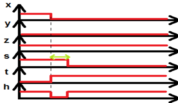
Figure 4-13. Chronogramme mettant en évidence les problèmes de fan-out reconvergeant
