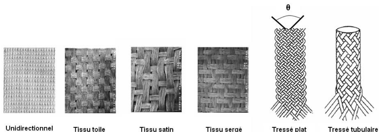
Figure 1 : Exemples d'architecture de renforts fibreux tissés (Feuvrier 2007).
