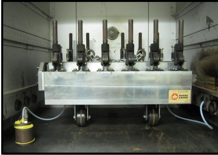
Figure 7 : Chauffage du moule dans le four.
