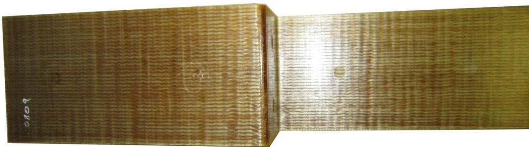
Figure 3-11 : Pièce mal imprégnée suite à un vide incomplet.
