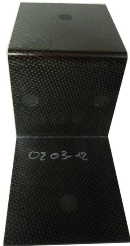
Figure 3-23 : Illustration d'une pièce carbone - époxy injectée à 35 psi et cuite à 200°C.
