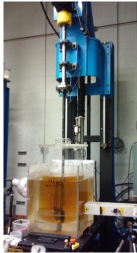
Figure 2.1: Photo du dispositif expérimental, un mélangeur Maxblend de 50L (volume maximal).
