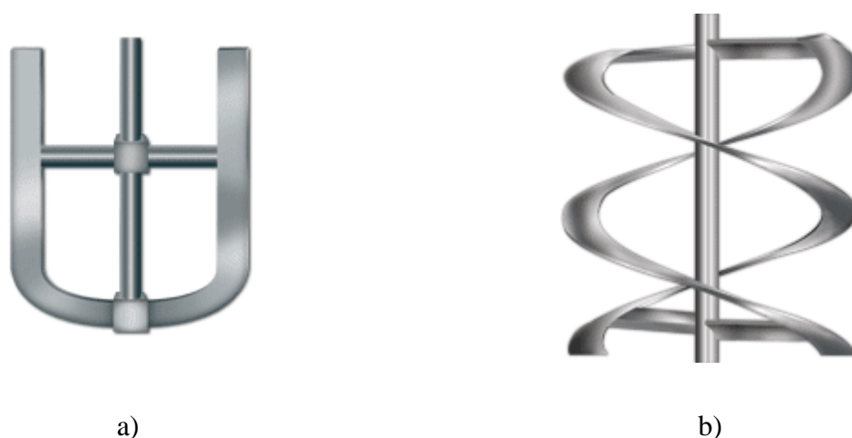
Figure 2: Mobiles raclants: a) ancre 3 ; b) double ruban hélicoïdal 4 .
