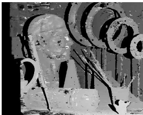
une passe sur les petites images, sans remplissage de disparités HD, MMC avec matrices de transition et d'émission par paramètre \sigma = 10^6 , taux d'erreur des pixels visibles : 36,62%
