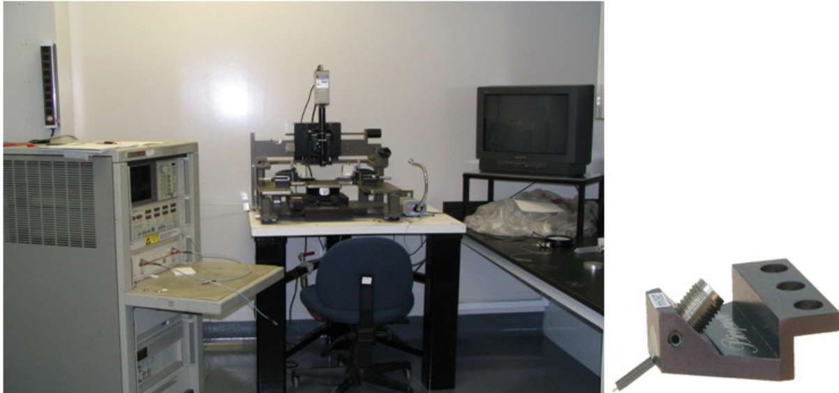
Figure 2-8 : Montage de mesure sous pointes avec analyseur HP8510 et sonde GSG de Picoprobe (photographie de la sonde tirée du site web de Semiprobe : http://www.semiprobe.com/store/in )
