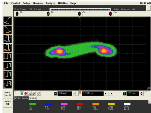
(d) Constellation of 50-Mbps BPSK signal.
