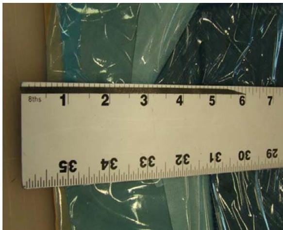
Figure 1-3 : Ruban de préimprégné carbone/époxy de 1/8'' de largeur
