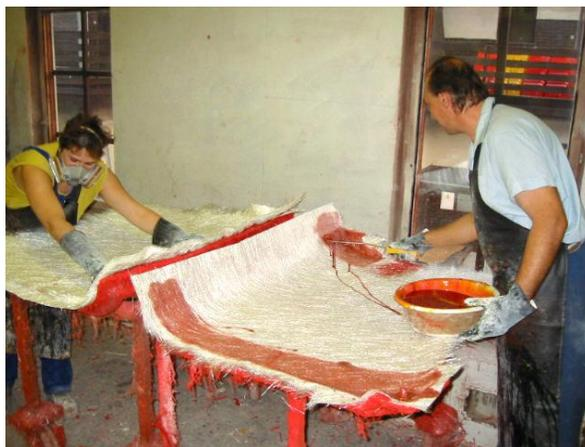
Figure 1-1: Fabrication par *hand lay-up* (photo de : <http://www.petergfk.com/en/technology/>)
