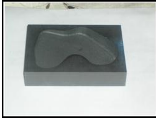
Figure 3-8 : Moule en zircone fabriqué par prototypage rapide (addition)
