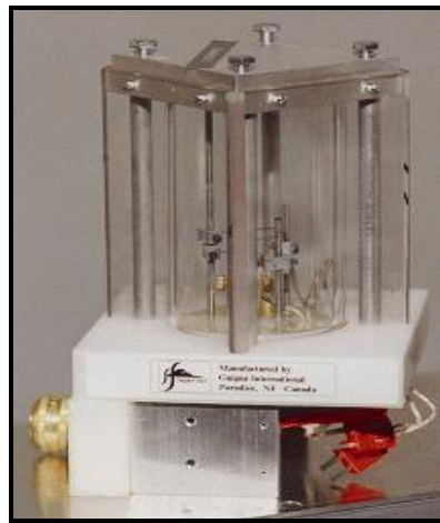
Figure 1-15 : Chambre de combustion solide
