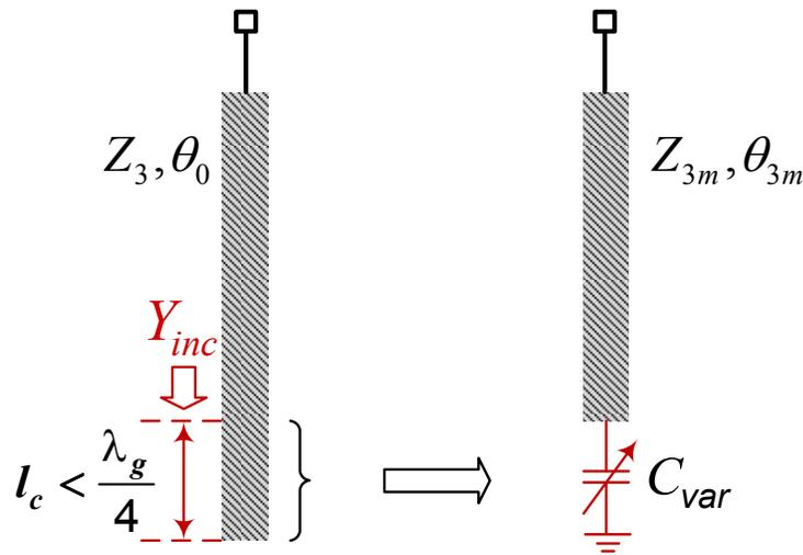
Figure 2.5 : Ligne de transmission ouverte et circuit équivalent
