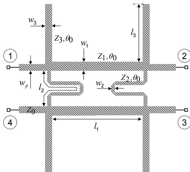
Figure 2.3 : Topologie du coupleur hybride quadrature multi-bande statiques
