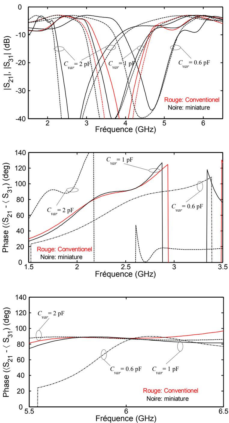
Figure 2.9 : Coefficients  $S_{21}$  (ligne solide),  $S_{31}$  (ligne pointillée) et différence de phase ( $S_{21}-S_{31}$ ) des coupleurs multi-bande statique (couleur rouge) et contrôlables (couleur noire) pour  $C_{var}=0.6, 1$  et  $2$  pF
