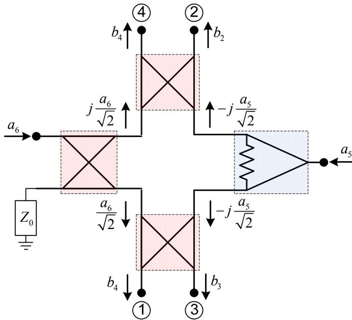
Figure 5.1 : Architecture d'une jonction six-port conventionnelle
