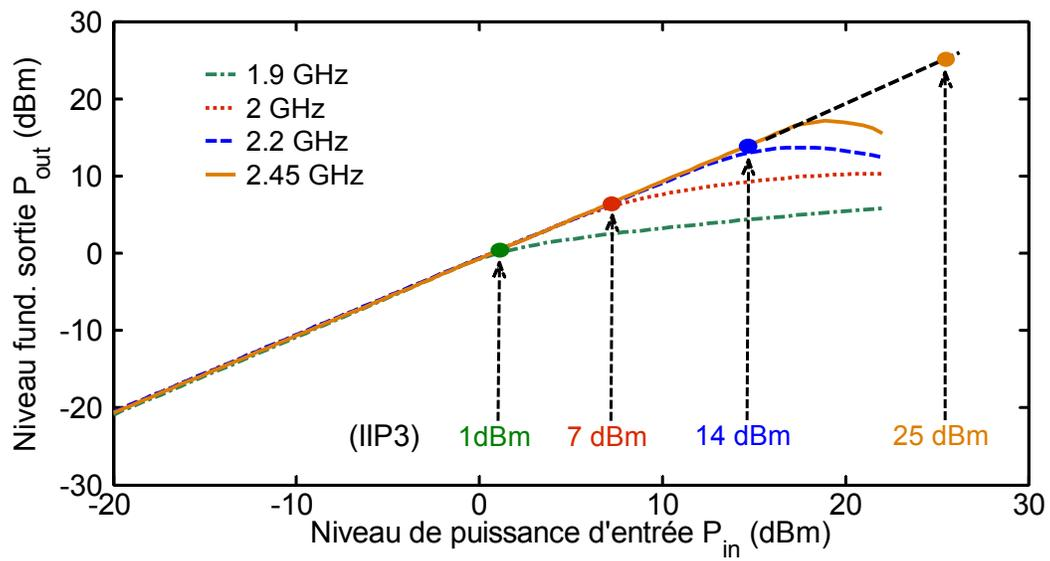
Figure 3.19 : Caractéristique simulée  $P_{out}$  vs  $P_{in}$  et mesure de l'IIP3 du filtre passe bande reconfigurable
