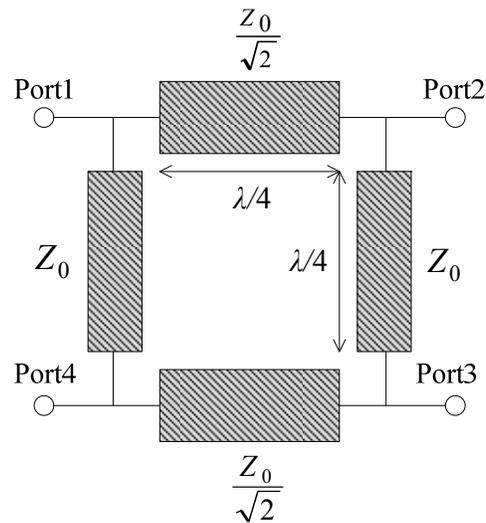
Figure 2.1: Topologie d'un coupleur hybride quadrature conventionnel
