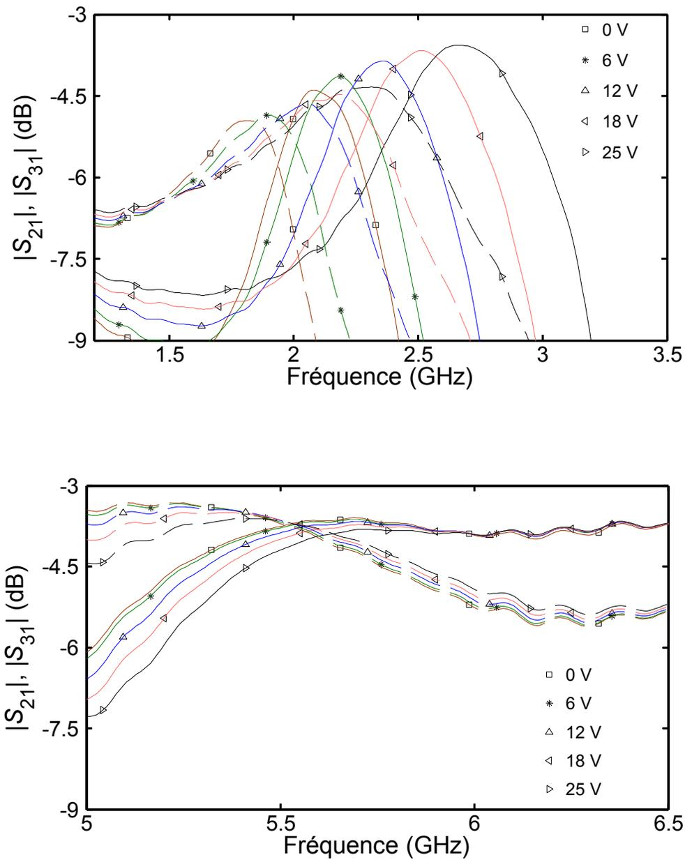
Figure 2.21 : Paramètres  $S_{21}$  et  $S_{31}$  mesurés aux bandes de fréquences inférieure (dessus) et supérieure (dessous) du coupleur hybride accordable avec des varactors BST
