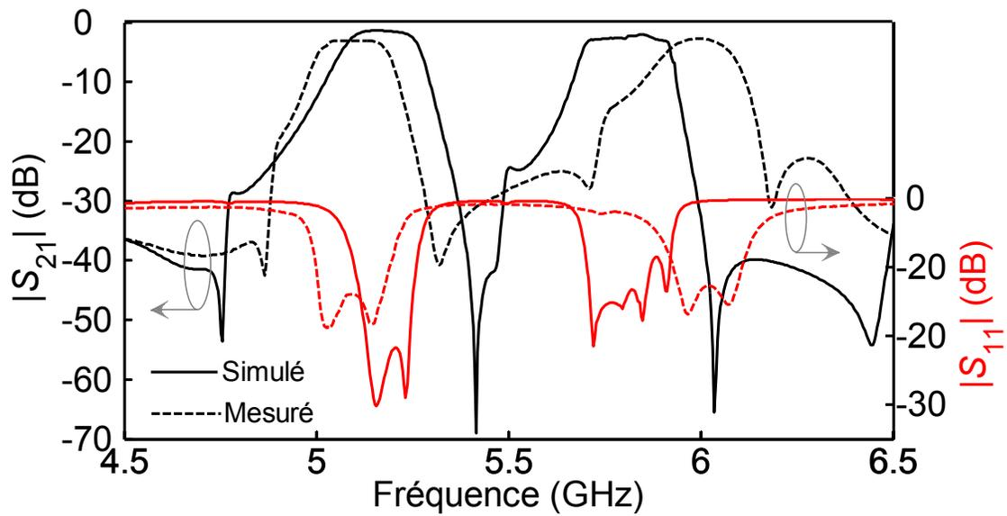
Figure 3.10 : Prototype du filtre bimode multi-bande multicouche ainsi que les paramètres  $S_{11}$ (dB),  $S_{21}$ (dB) simulés et mesurés
