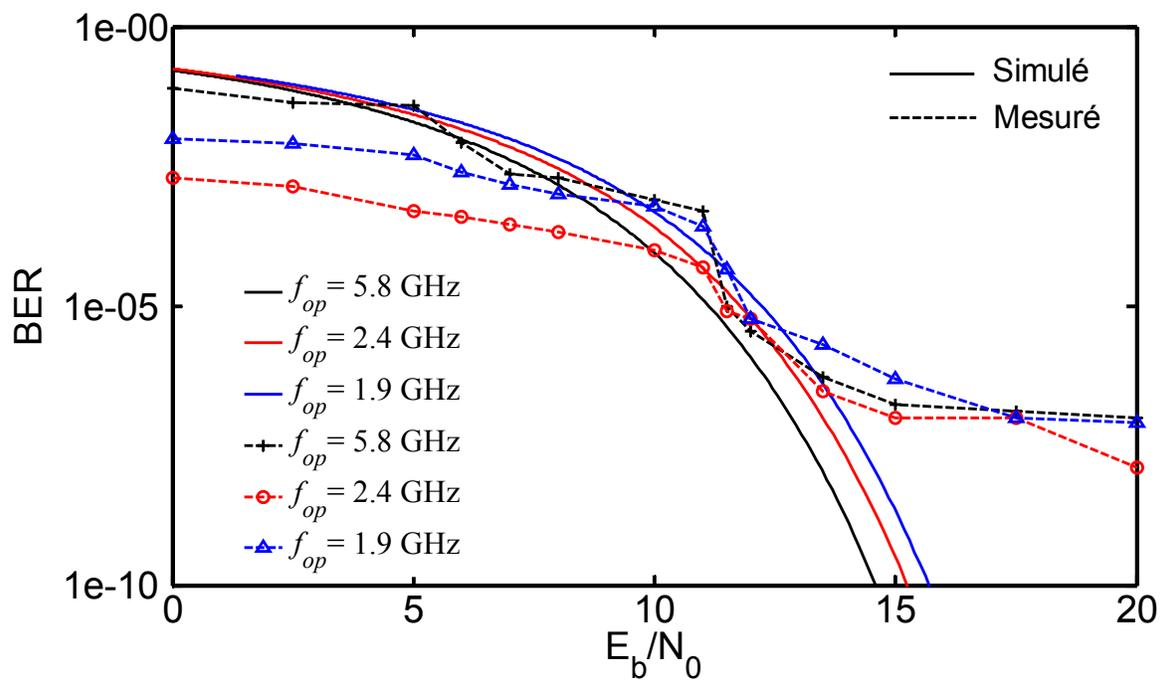
Figure 5.25 : BER mesurés en fonction de  $E_b/N_0$  du récepteur six-port reconfigurable à différentes fréquences centrales d'opération  $f_{op} = 1.9$  GHz ( $V_{bias} = 5$  volt), 2.4 GHz ( $V_{bias} = 15$  volt), et 5.8 GHz ( $V_{bias} = 0$  volt)
