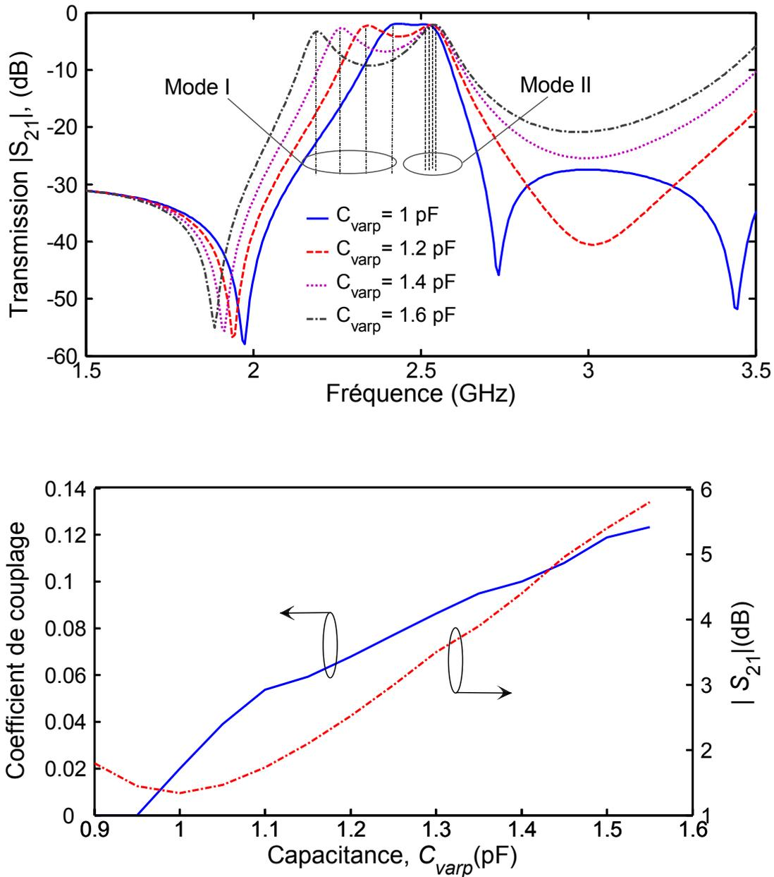
Figure 3.13 : Perte d'insertion  $S_{21}$ (dB) simulée du filtre deux pôles contrôlable, et coefficient de couplage  $M_{12}$  entre les modes  $TM_{100}$  et  $TM_{010}$  en fonction de la capacitance de charge  $C_{varp}$
