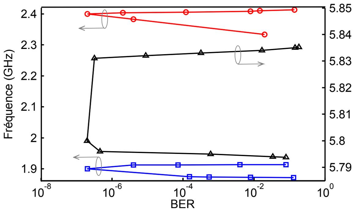
Figure 5.26 : BER mesurés en fonction de la fréquence  $f_s$  d'un signal QPSK reçu sans bruit ajouté du récepteur six-port reconfigurable à différentes fréquences centrales d'opération  $f_{op} = 1.9$  GHz ( $V_{bias} = 5$  volt), 2.4 GHz ( $V_{bias} = 15$  volt), et 5.8 GHz ( $V_{bias} = 0$  volt)
