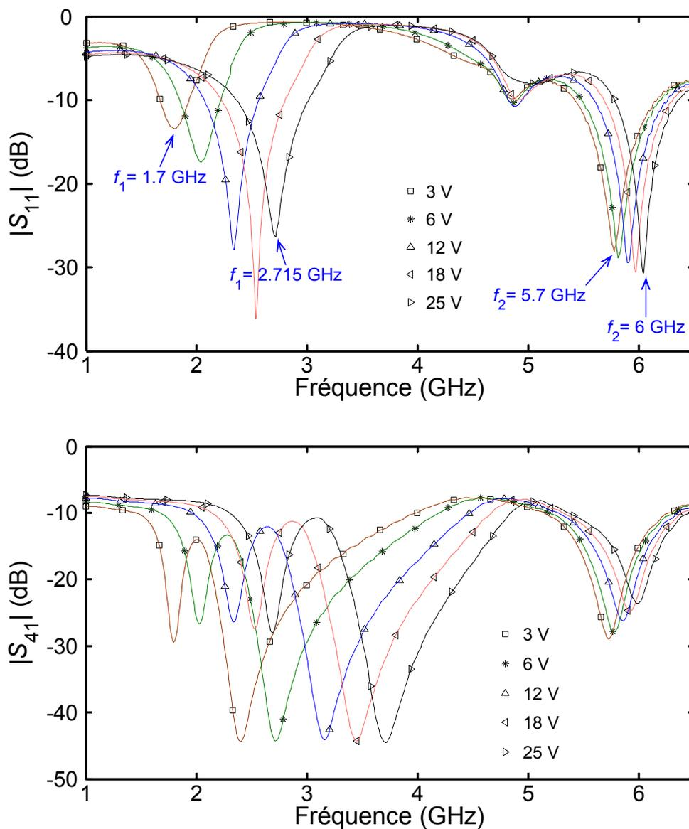
Figure 2.18 : Paramètres  $S_{11}$  (dessus) et  $S_{41}$  (dessous) mesurés du coupleur hybride accordable avec des varactors semiconducteur
