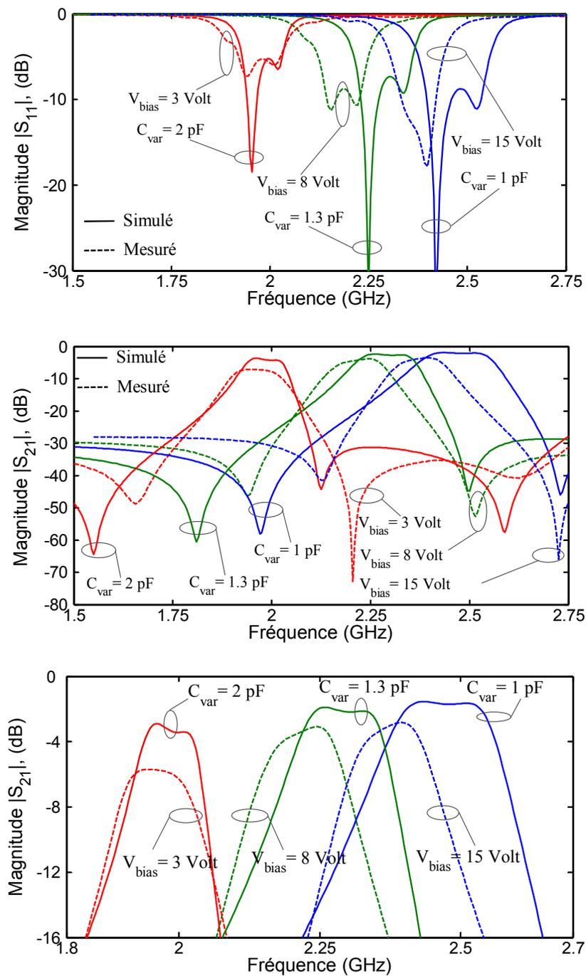
Figure 3.18 : Perte d'insertion  $S_{21}$ (dB) et adaptation ( $S_{11}$ ) simulées et mesurées du filtre deux pôles contrôlable, pour différentes capacitances  $C_{\text{var}}$  et de tensions de polarisation  $V_{\text{bias}}$
