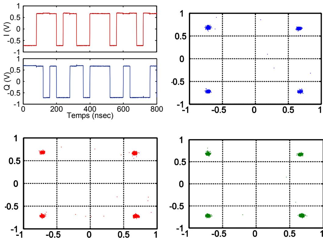
Figure 5.23 : Séquences de signaux I/Q mesurées par rapport au temps (dessus coin gauche), et constellations du signal QPSK démodulé sans bruit ajouté aux fréquences d'opération de 1.9 GHz (dessus coin droit), 2.45 GHz (dessous coin gauche) et 5.8 GHz (dessous coin droit)
