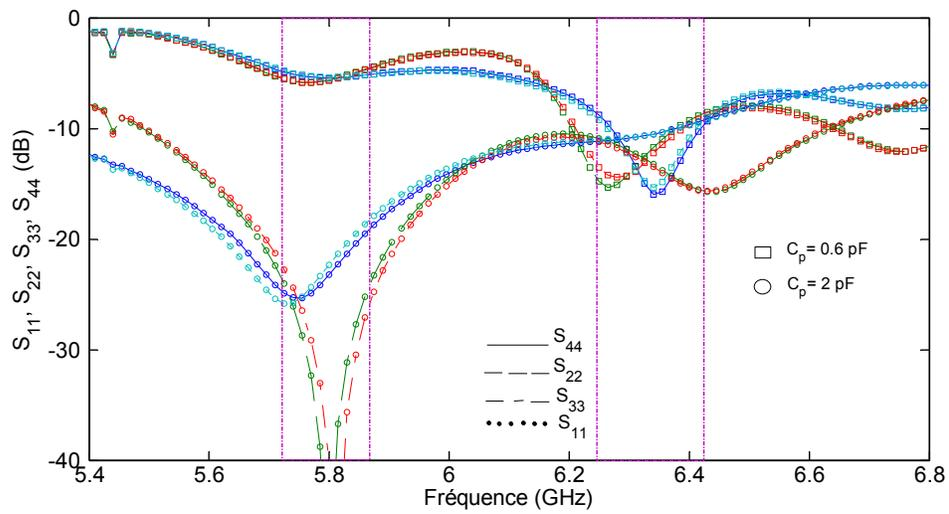
Figure 5.6 : Adaptations ( $S_{11}$ ,  $S_{22}$ ,  $S_{33}$ ,  $S_{44}$ ) aux ports de sorties
