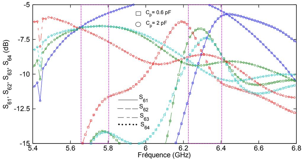
Figure 5.7 : Pertes d'insertions ( $S_{61}$ ,  $S_{62}$ ,  $S_{63}$ ,  $S_{64}$ ) entre le port d'entrée RF (6) et les sorties 1, 2, 3, et 4
