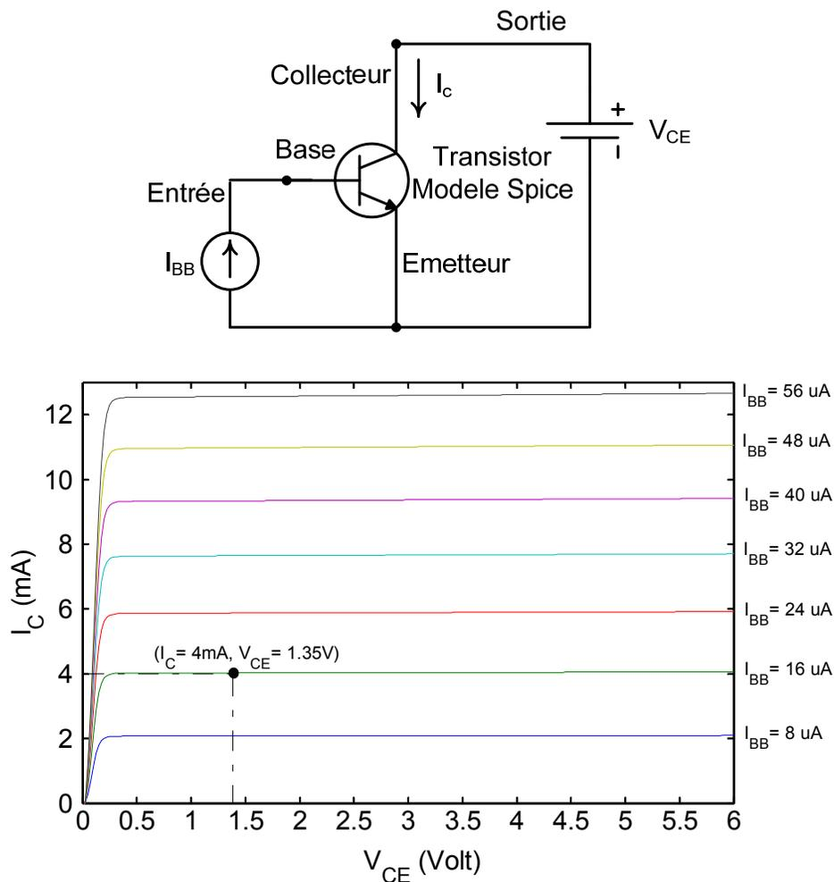
Figure 4.3 : Configuration émetteur-commun et caractéristiques de transfert DC du transistor RF *npn* SiGe BJT BFP640
