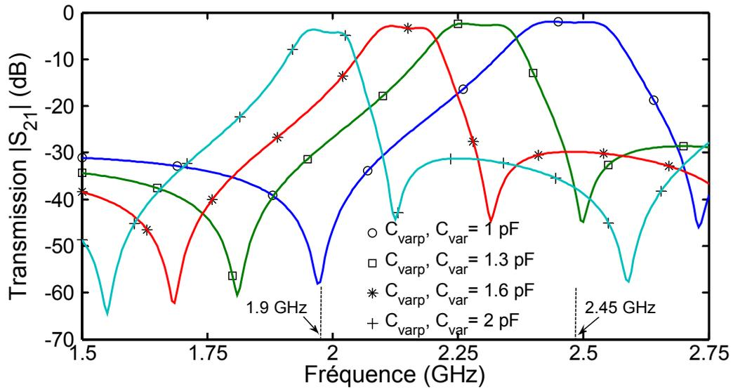
Figure 3.16: Perte d'insertion  $S_{21}$ (dB) simulée du filtre deux pôles contrôlable en fonction des capacités  $C_{var}$  et  $C_{varp}$
