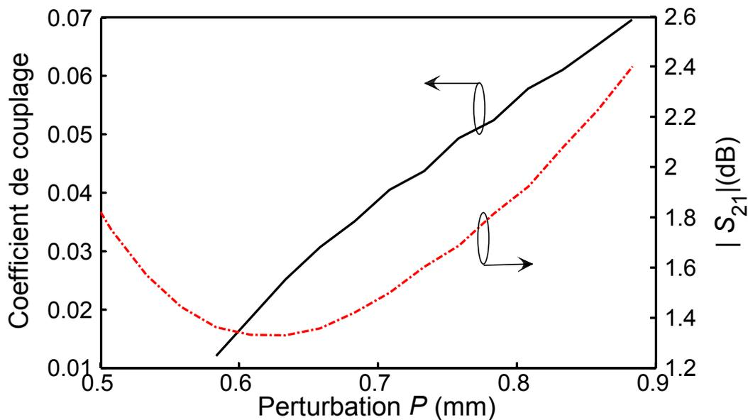
Figure 3.3 : Perte d'insertion  $S_{21}$ (dB) simulé du filtre deux pôles, et coefficient de couplage entre les modes  $TM_{100}$  et  $TM_{010}$  en fonction de la perturbation  $p$
