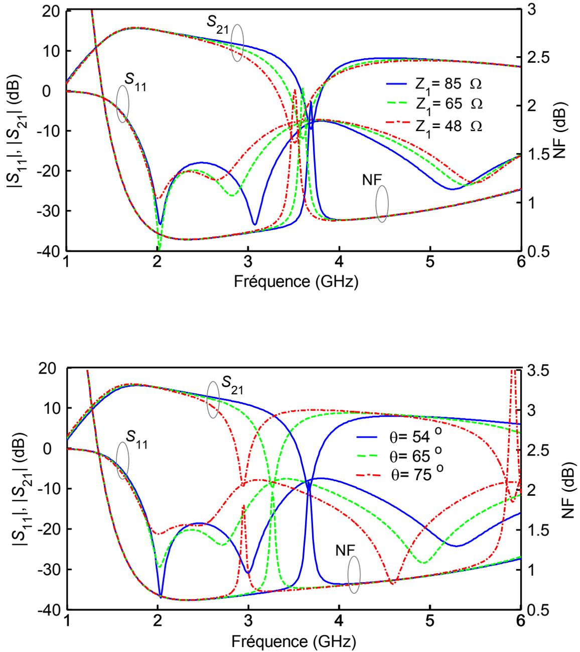
Figure 4.8 : Performances simulées du LNA de la Figure 4.7 pour des valeurs de  $\theta_1 = \theta_2 = 54^\circ$ ,  $Z_2 = 48 \Omega$  (dessus), et  $\theta = \theta_1 = \theta_2$ ,  $Z_1 = 85 \Omega$ , et  $Z_2 = 48 \Omega$  (dessous).
