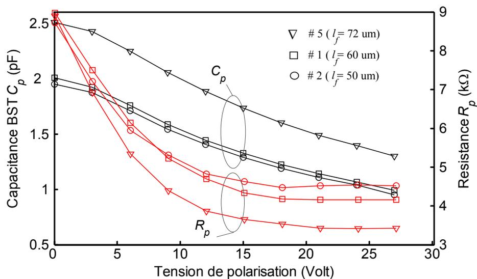
Figure 1.8 : Extraction à la fréquence de 1GHz de la capacitance et la résistance  $C_p$  et  $R_p$  pour différents capacités IDC, avec  $R_s = 1 \Omega$ , et ( $\nabla$ )  $L_s = 0.0125$  nH, ( $\square$ )  $0.01$  nH, ( $\circ$ )  $0.0075$  nH
