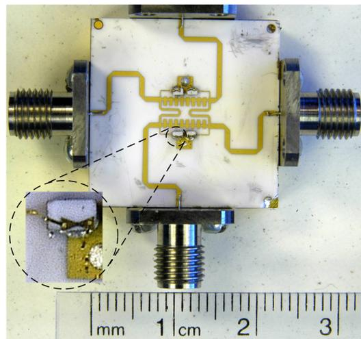
Figure 2.17: Photographie des coupleurs hybrides accordables avec les varactors semiconducteur (dessus) et varactors BST (dessous)
