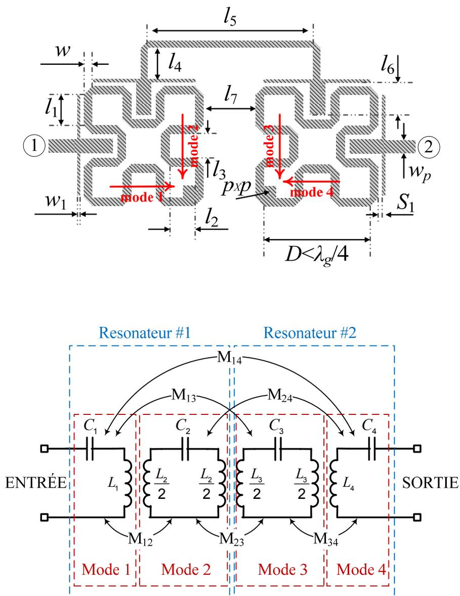
Figure 3.4 : Filtre bimodes quatre pôles quasi-elliptiques (dessus) et modèle circuit équivalent (dessous)
