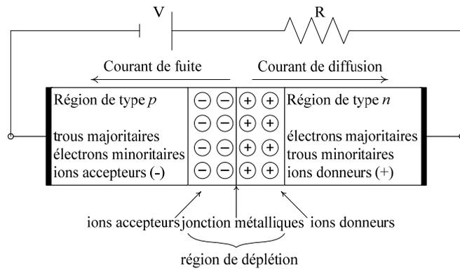
Figure 2.13 : Jonction  $pn$  de la diode polarisée inverse
