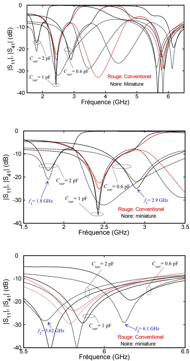
Figure 2.8 : Coefficients  $S_{11}$  (ligne solide) et  $S_{41}$  (ligne pointillée) des coupleurs multi-bande statique (couleur rouge) et contrôlables (couleur noire) pour  $C_{var} = 0.6, 1$  et  $2$  pF
