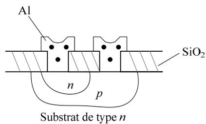
Figure 2.11 : Schéma d'une diode  $pn$  réalisée sur un circuit intégré. Le substrat est de type  $n$ . Les contacts métalliques sont en alumine et la couche de  $\text{SiO}_2$  sert d'isolant électrique
