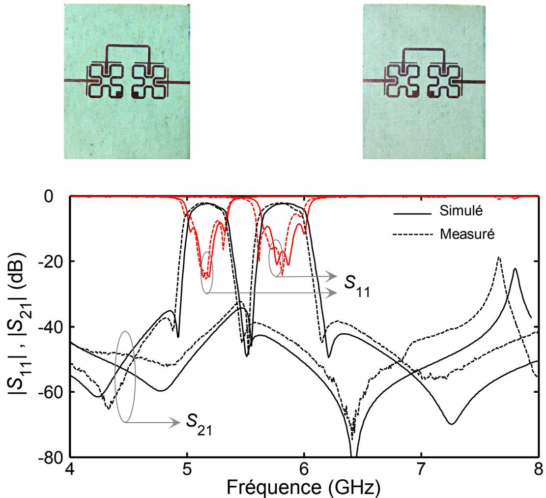
Figure 3.6 : Prototypes des filtres passe bande bimode d'ordre quatre aux fréquences centrale de 5.2 GHz (gauche) et à 5.8 GHz (droite), ainsi que les paramètres  $S_{11}$ (dB),  $S_{21}$ (dB) simulés et mesurés
