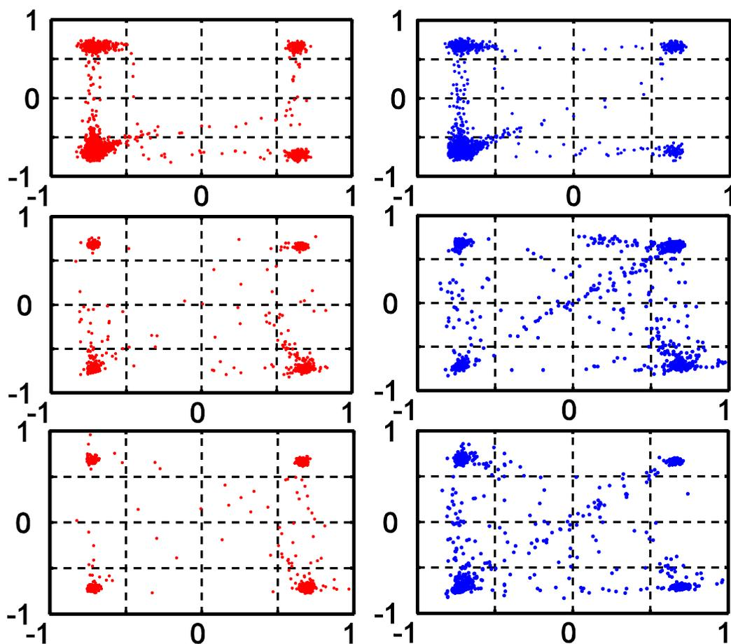
Figure 5.24 : Constellations du signal QPSK démodulé mesurées avec  $E_b/N_0$  de 18 dB (dessus, milieu et dessous coin gauche) et 5 dB (dessus, milieu et dessous coin droit), aux fréquences d'opération de 1.9 GHz (dessus, coin gauche et droit), 2.45 GHz (milieu, coin gauche et droit), et 5.8 GHz (dessous, coin gauche et droit)
