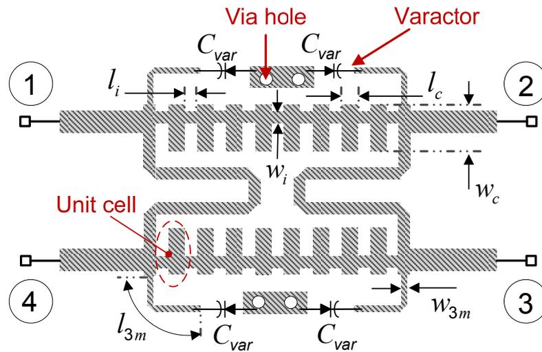
Figure 2.7 : Topologie du coupleur hybride quadrature multi-bande contrôlables
