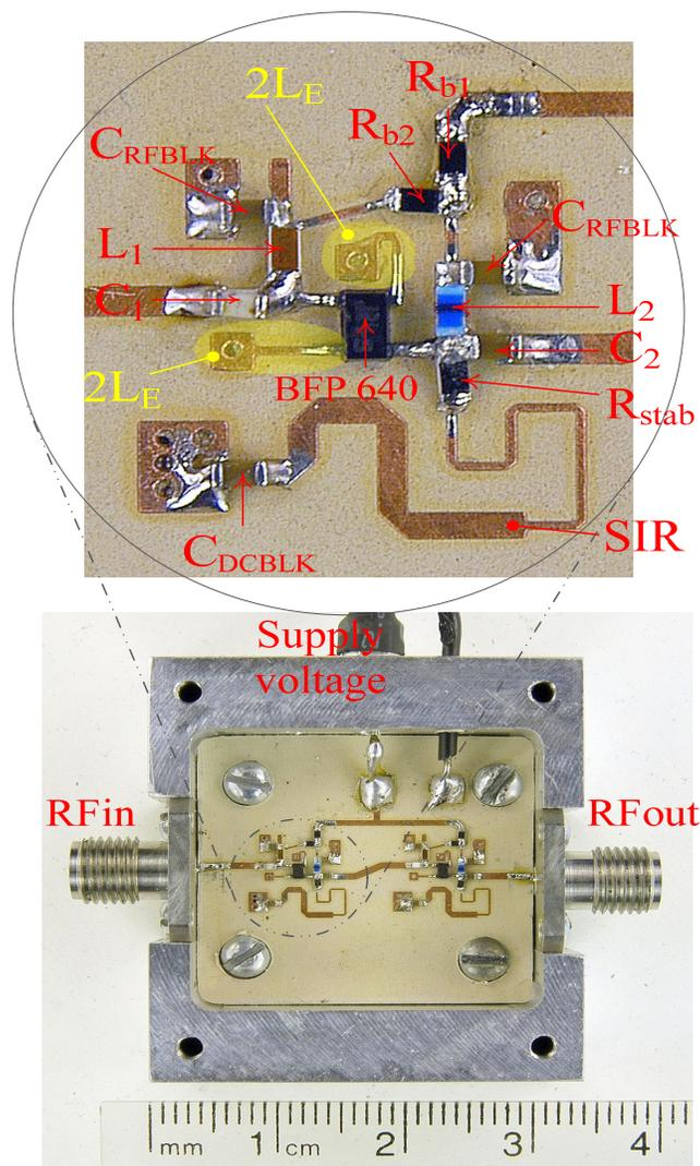
Figure 4.9 : Prototype fabriqué du LNA deux étages multi-bande
