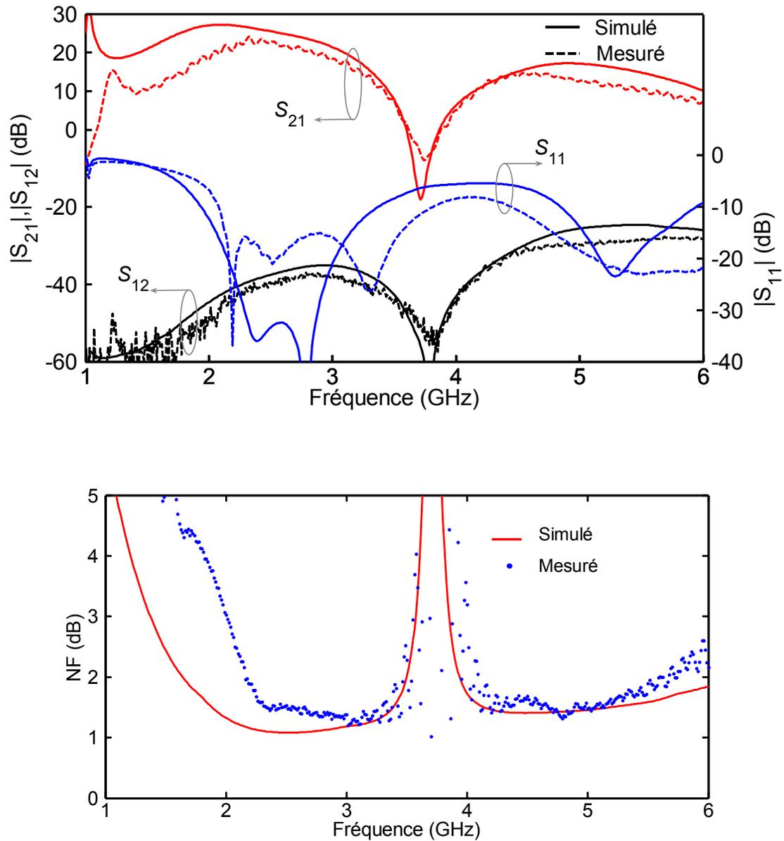
Figure 4.10 : Performances simulées et mesurées du gain, de l'adaptation, de l'isolation (dessus), et de la figure de bruit (dessous) du LNA multi-bande
