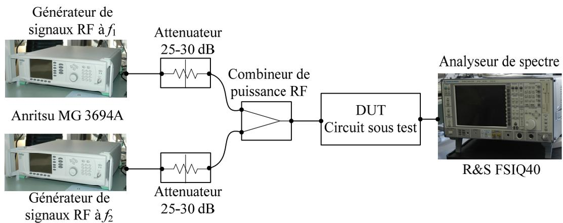
Figure A.2.2 : Schématique du setup de mesures de linéarité
