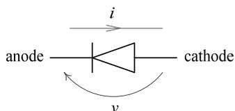
Figure 2.12 : Symbole électrique d'une diode à jonction  $pn$
