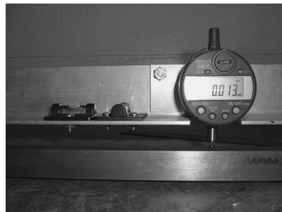
a) extensomètre sur la barre de référence
