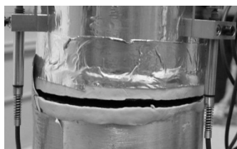
a) rupture à la base de l'éprouvette
