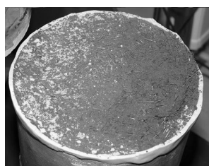
b) Surface inférieure de la rupture (côté casque)
