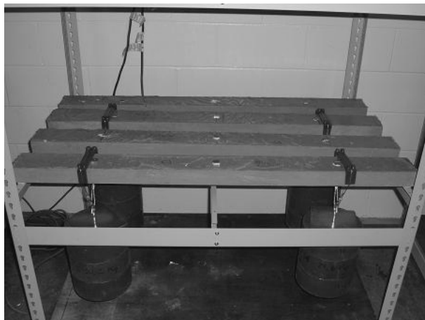
Figure A.1 Montage pour l'essai de fluage en flexion
