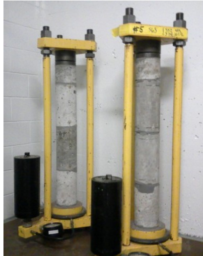
Figure 2.4 Bâties pour l'essai de fluage en compression
