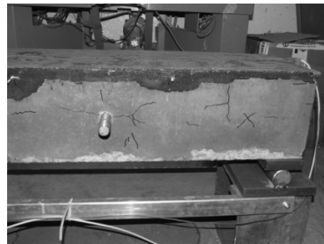
Figure 6.7 Montage pour l'étude du comportement déformationnel d'une poutre réparée
