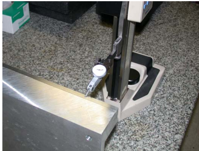
Figure 3-8: Comparateur utilisé pour vérifier le défaut de forme linéaire.
