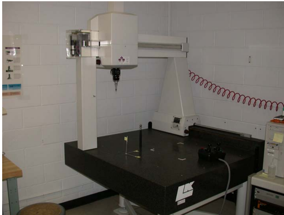
Figure 3-6: MMT du LRFV de marque LK tool modèle G90C.
