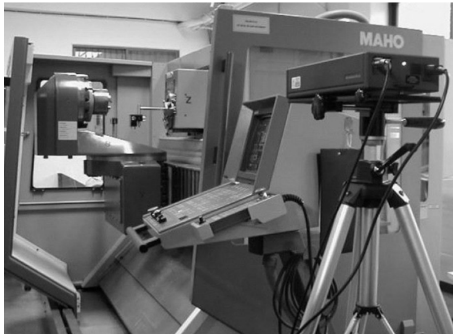
Figure 1-4 : Mesure directe par interféromètre laser [10]
