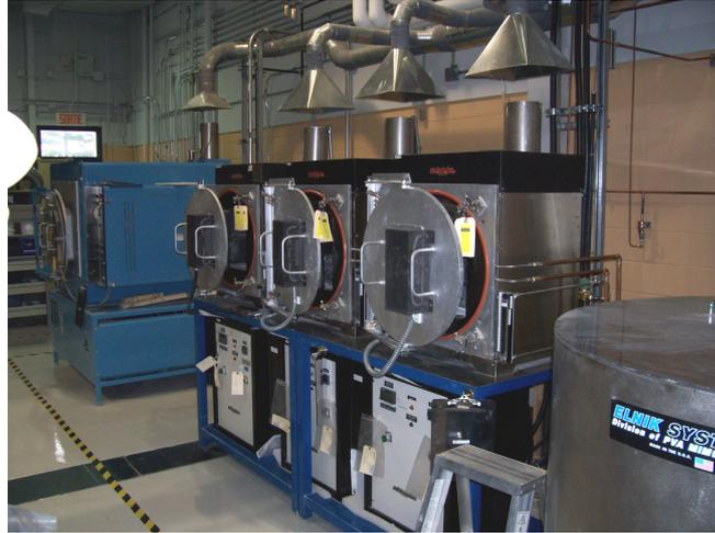
Figure 4.7 : Photo des fours de déliantage.
