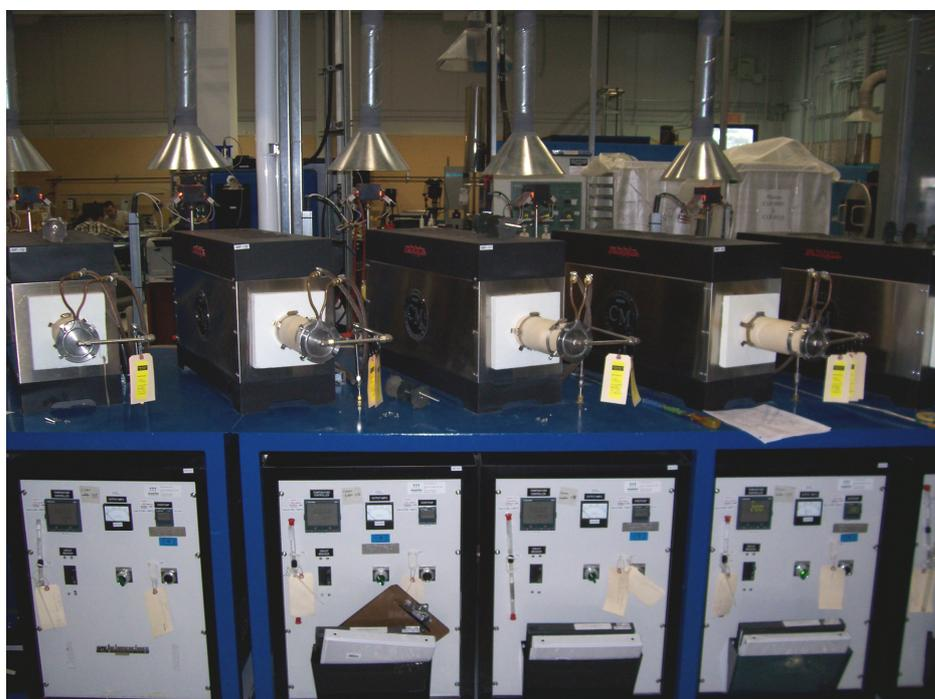
Figure 4.9 : Photo des fours tubulaires de frittage.
