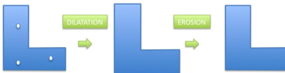
Figure A.16 Filtre morphologique pour combler les trous
