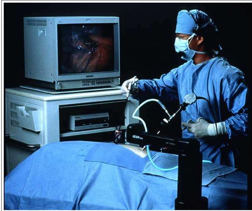
Figure 4.2 Robot Aesop utilisé en chirurgie thoracoscopique
