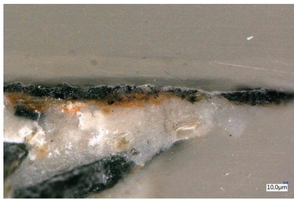
Fig. 12 et 12b. Bordes-Uchentein (Ariège), église Saint-Pierre d'Ourjout ; trace de cordeau identifié au niveau de l'abside. © LRMH.
