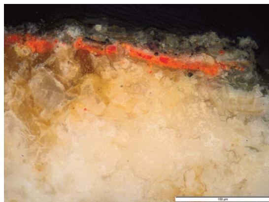
Fig. 9. Puisserguier (Hérault), maison du viguier ; détail de la stratigraphie de l'échantillon noir prélevé sur le blason de Georges d'Amboise (closoir C64), observée sous microscope optique. On constate qu'une couche de badigeon noir recouvre une fine couche blanche correspondant à de l'orpiment dégradé et appliquée sur une couche picturale rouge de vermillon. S. Boularand © CICRP.
