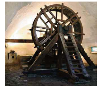
Fig. 9. Puits avec roue à écureuil, mue par un homme marchant debout à l'intérieur. Citadelle de Mont-Louis dans les Pyrénées-Orientales, XVII e siècle. © RETP Mont-Louis.
