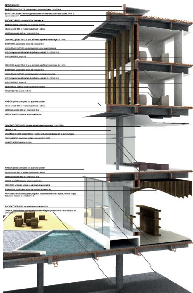
Figura 11 Visualización 3d detalle constructivo Elaboración propia
