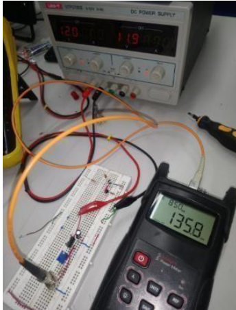
Figura 9. Corriente 1,35 mA, Potencia 0,135 micro Wattios
