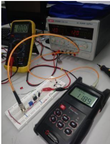
Figura 10. Corriente 2 mA, Potencia 11,89 micro Wattios
