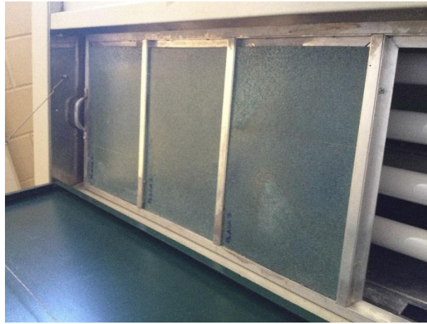
Ilustración 21 Preparación para prueba de resistencia ante rayos ultra violetas
