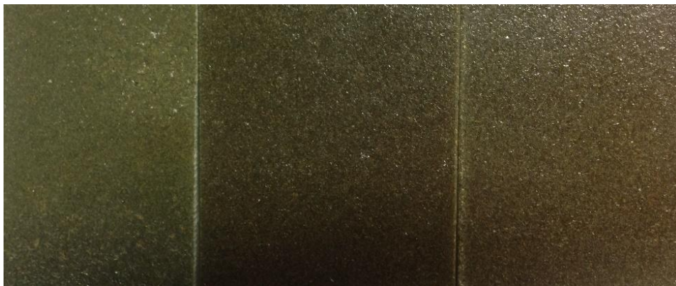
Ilustración 22 Resultados de prueba de exposición a rayos ultra violeta
