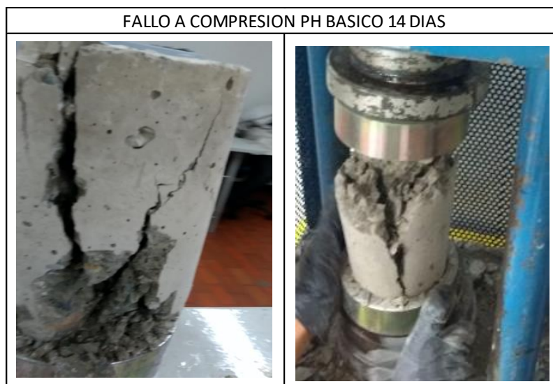
Figura 18. Fallo a compresión PH Básico a 14 Días
