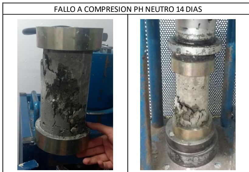
Figura 15. Fallo a compresión PH Neutro a 14 Días
