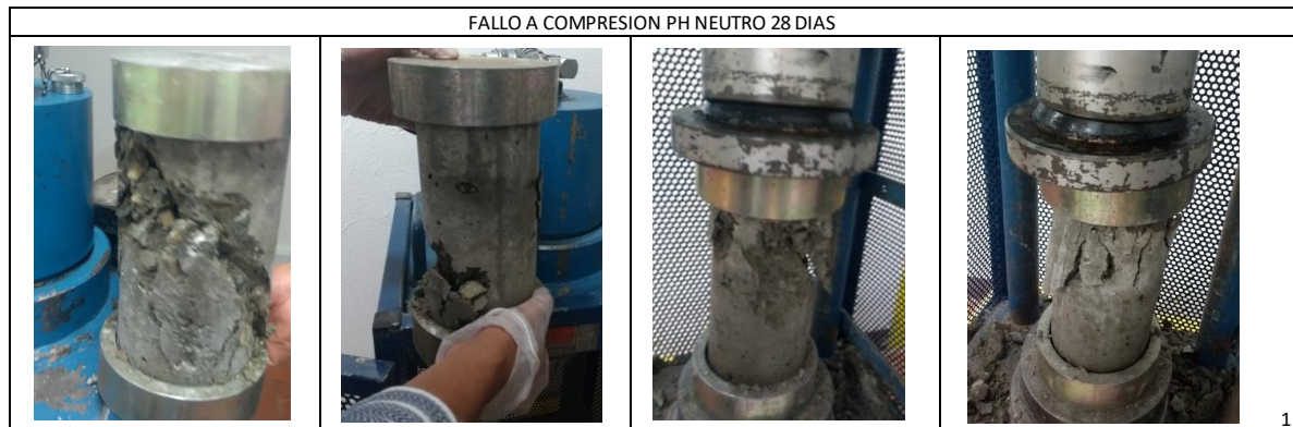
Figura 16. Fallo a compresión PH Neutro a 28 Días
