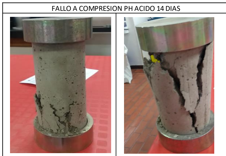
Figura 12. Fallo a compresión PH Acido a 14 Días
