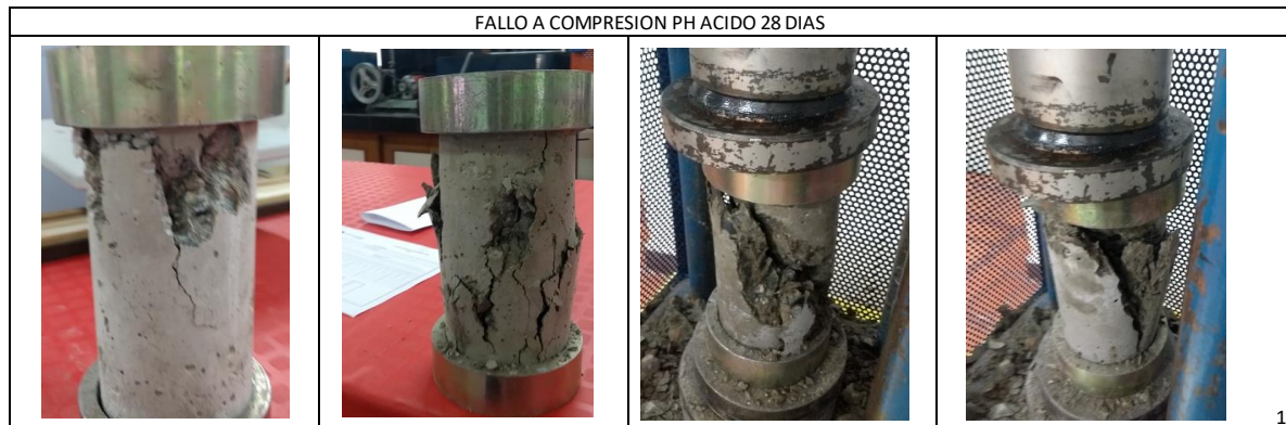
Figura 13. Fallo a compresión PH Acido a 28 Días
