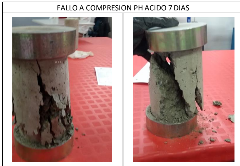
Figura 11. Fallo a compresión PH Acido a 7 Días
