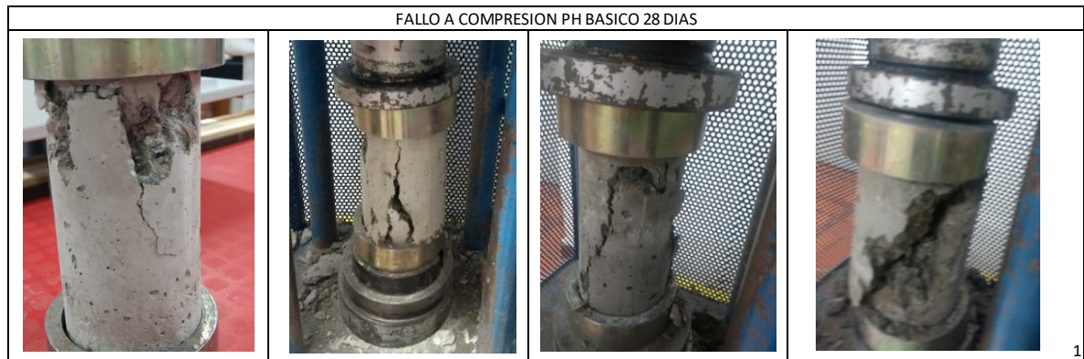
Figura 19. Fallo a compresión PH Básico a 28 Días
