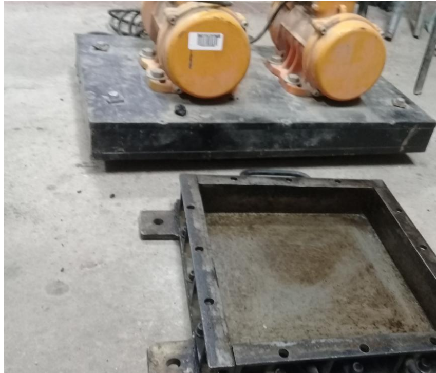
Imagen 21 Equipo para fabricación de placas de pavimento
