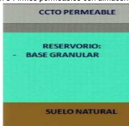
Imagen 5 Firmes permeables con almacenamiento
