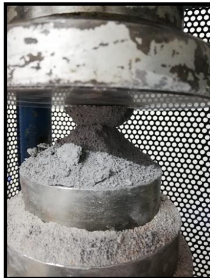
Gráfica 9. Falla de morteros de cenizas curados en horno
