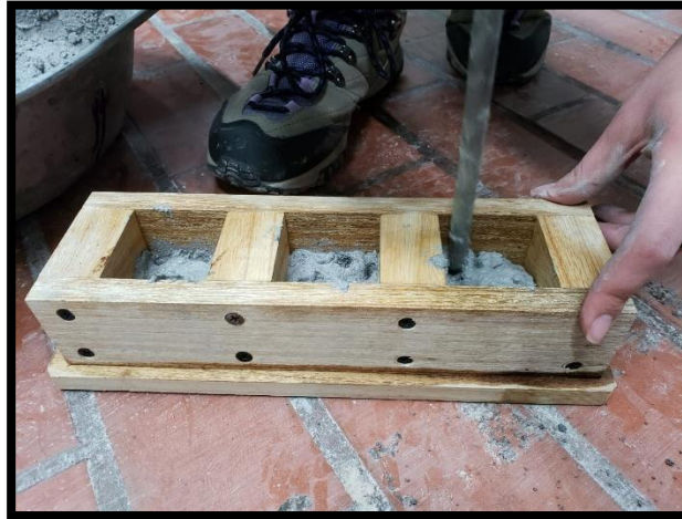
Figura 27. Proceso de compactación de morteros
