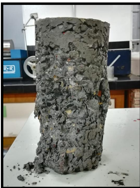
Figura 32. Falla de cilindro de concreto de cenizas con relación A/C 0,60
