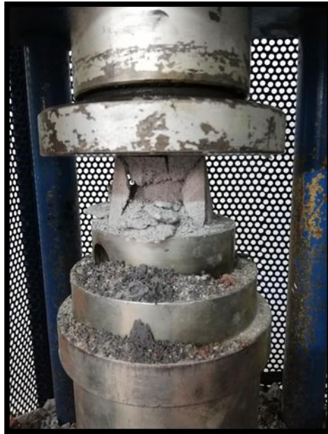
Figura 37. Falla de mortero de cenizas curado a temperatura ambiente
