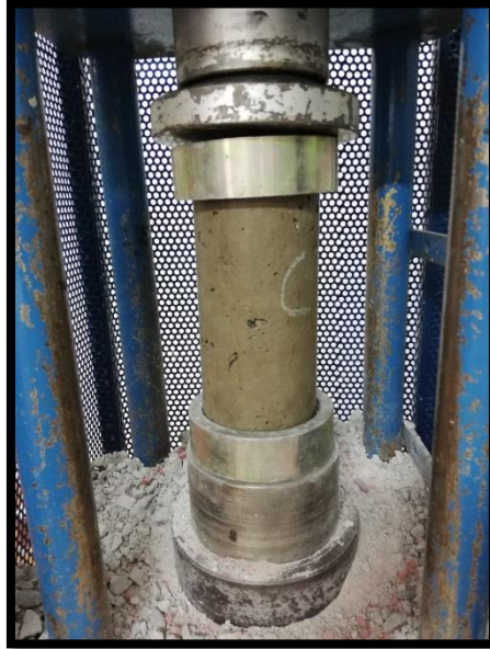
Figura 20. Cilindro de concreto convencional sometido a carga
