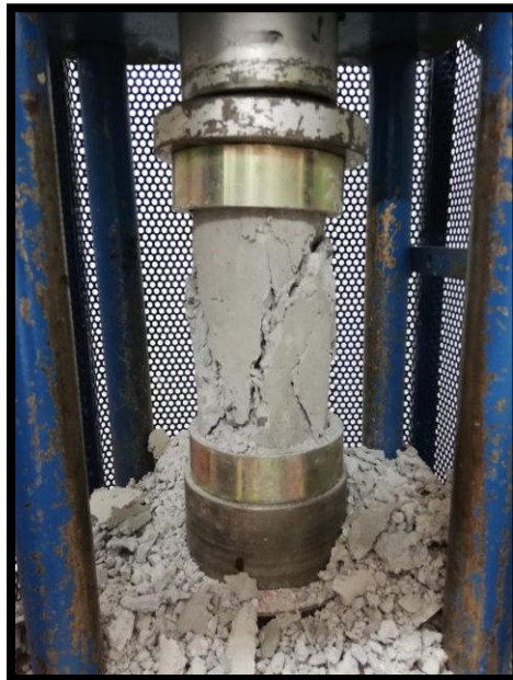
Figura 31. Falla de cilindro de concreto de cenizas con relación A/C 0,50
