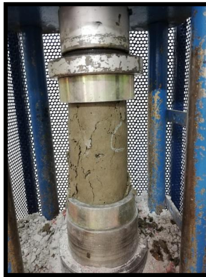
Figura 33. Falla de cilindro de concreto convencional
