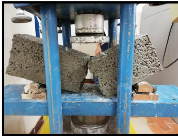
Figura 35. Falla de viga de concreto de cenizas
