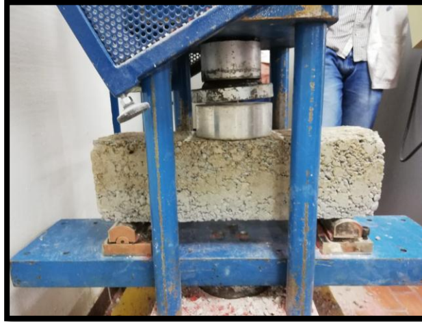
Figura 24. Viga de concreto de cenizas con carga aplicada
