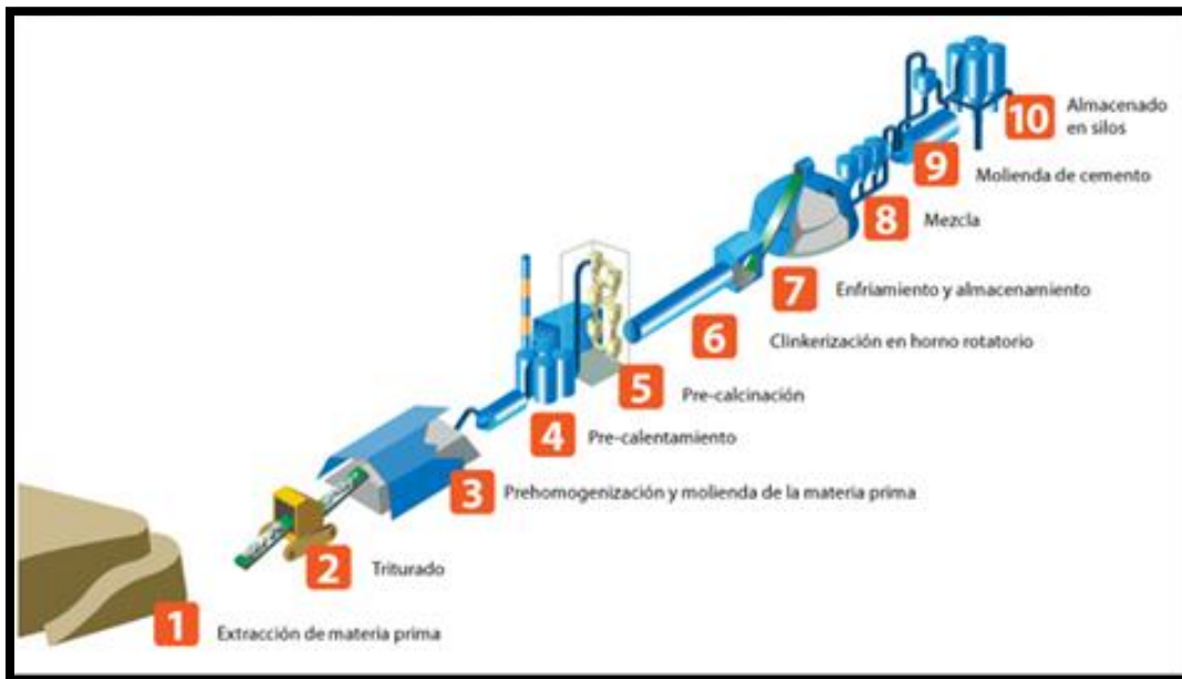
Figura 1. Etapas de fabricación del cemento portland
