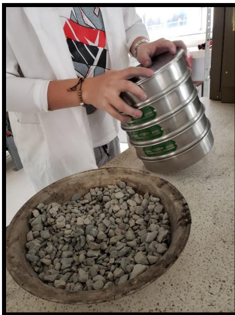
Figura 15. Preparación de granulometría para cilindros metálicos de 4"
