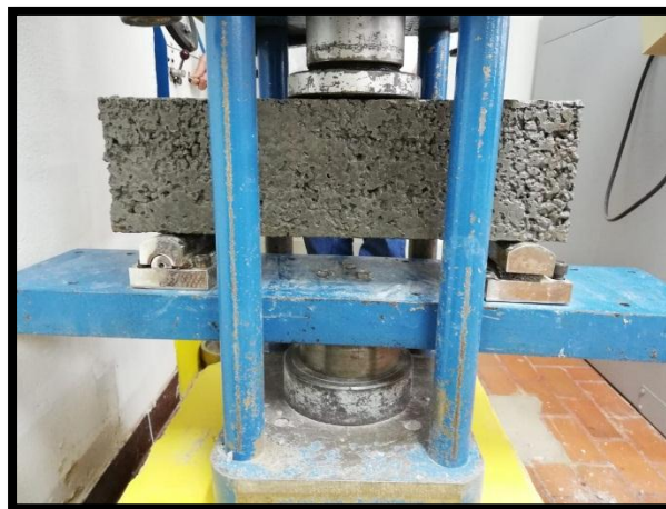
Figura 23. Viga de concreto convencional con carga aplicada
