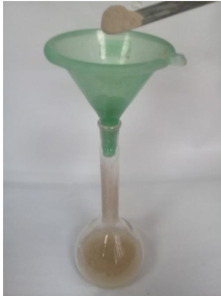
Figura 18. Ensayo de gravedad específica.
