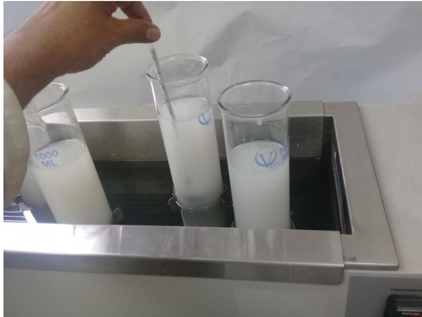
Figura 22. Lecturas con Hidrómetro 152H
