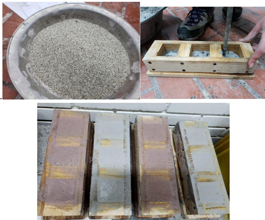
Figura 28 Procedimiento para realizar cubos de mortero 50mmx 50mm.
