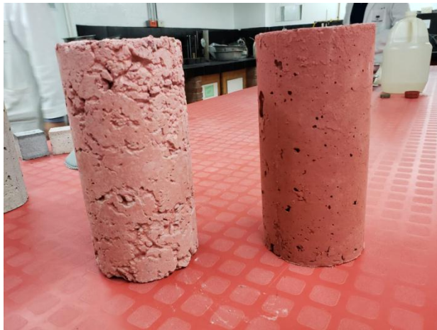
Figura 35 Especímenes de concreto generados a partir de suelo diatomáceo variando la cantidad de agua incorporada en la mezcla.
