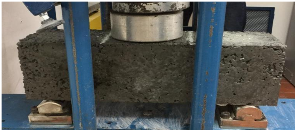
Figura 41 Viga de concreto generada a partir de CP
