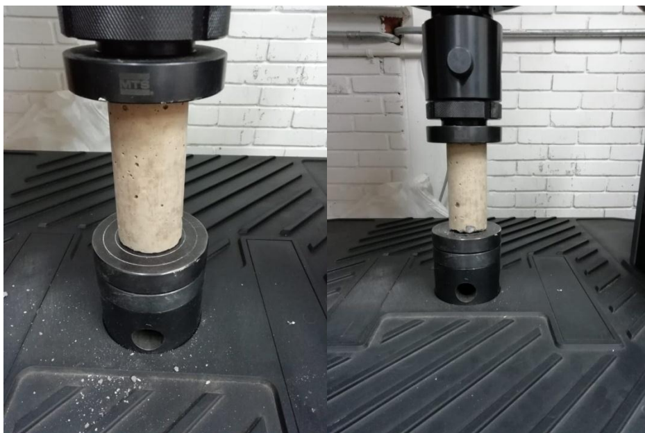
Figura 29 Ensayo de Compresión de Cilindros Ensayos Previos
