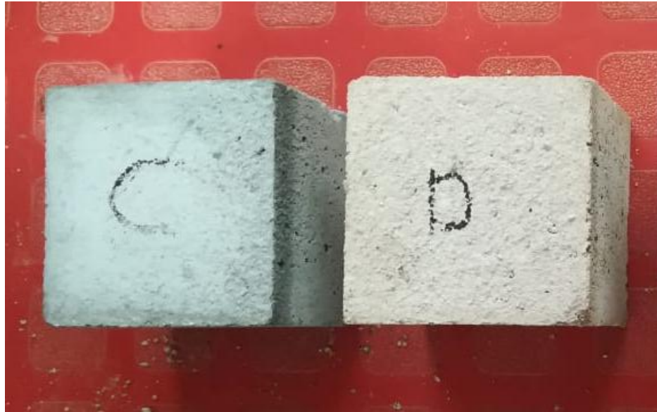
Figura 48 Mortero generado a partir de suelo diatomáceo y mortero de CP
