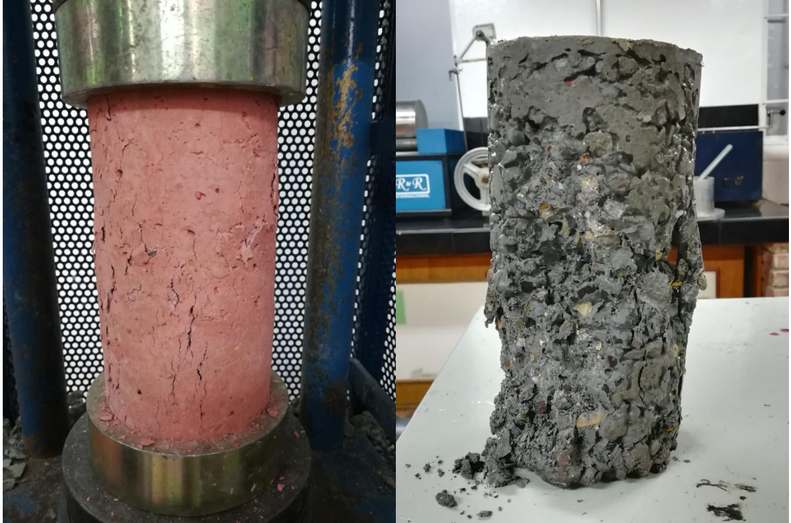
Figura 36 Falla de ensayo a compresión de Cilindros de concreto generado a partir de suelo diatomáceo (Lado izquierdo) Falla de ensayo a compresión de Cilindros de concreto generado a partir de CP (Lado derecho)
