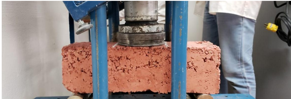
Figura 43 Ensayo de resistencia la Flexión de Vigas de concreto generadas a partir de suelo diatomáceo
