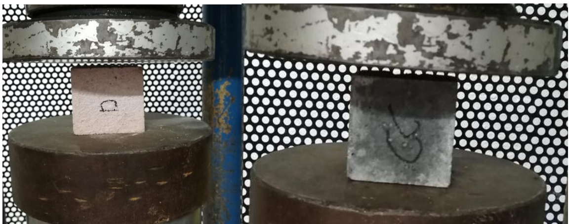
Figura 49 Ensayo de resistencia de morteros generados a partir de suelo diatomáceo (Lado izquierdo) y Ensayo de resistencia de morteros generados a partir de CP (Lado Derecho)
