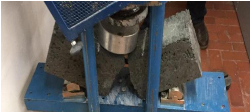
Figura 44 Ensayo de resistencia la Flexión de Vigas de concreto generadas a partir de CP
