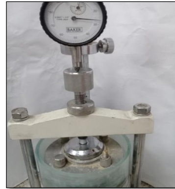
Montaje de la muestra en el Consolidómetro
