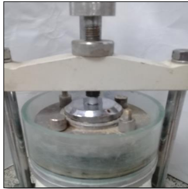
Montaje de la muestra en el Consolidómetro
