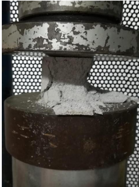
Ilustración 24 Falla en cubos de mortero con MK A/C=0,5
