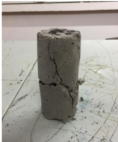
Ilustración 12 Falla cilindro de concreto con MK de prueba 1
