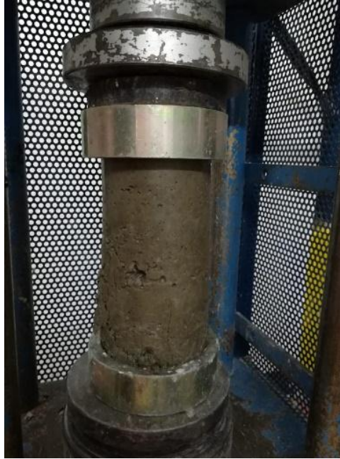
Ilustración 16 Falla en cilindros de concreto con CC A/C=0,5
