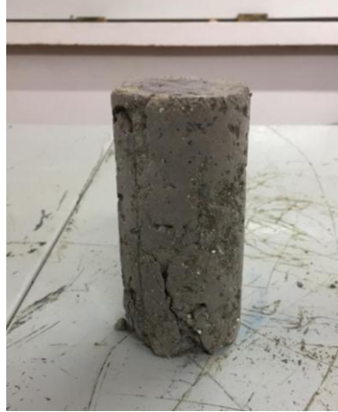
Ilustración 13 Falla cilindro de concreto con MK de prueba 2
