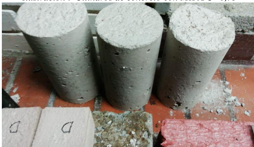
Ilustración 9 Cilindros de concreto con MK A/C=0,75
