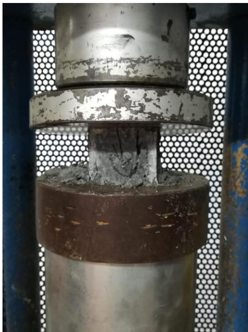
Ilustración 25 Falla en cubos de mortero con CC A/C=0,5
