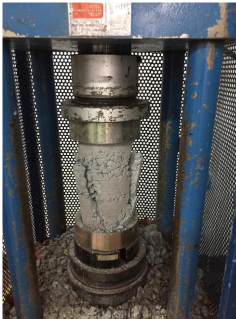
Ilustración 15 Falla en cilindros de concreto con MK A/C=0,5
