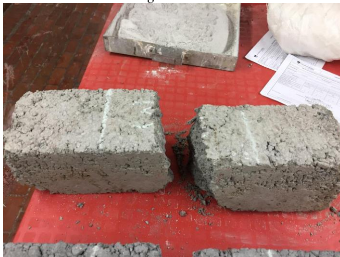
Ilustración 21 Falla en vigas de concreto con MK A/C=0,5
