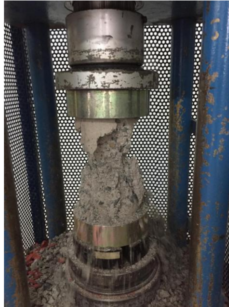
Ilustración 17 Falla en cilindros de concreto con MK A/C=0,75
