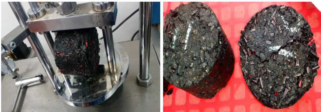
Figura 24 Briqueta modificada para prueba de resistencia a tracción a 25 grados Celsius en prensa Marshall.
