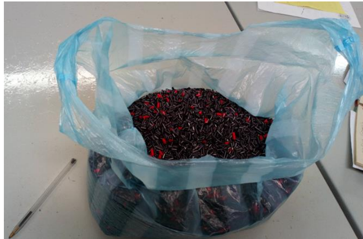
Figura 12 Material polipropileno de baja densidad PBD mezclador de tinto de 9cm cortado en 5mm
