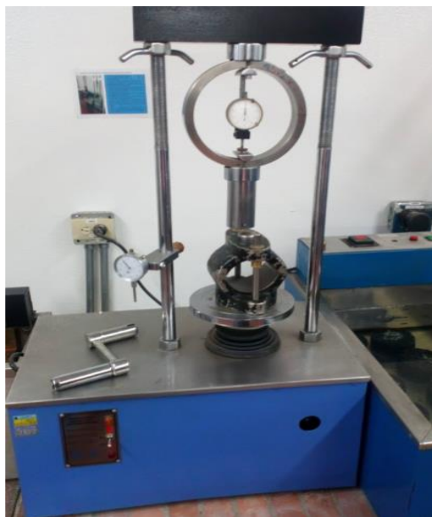
Figura 5 Máquina de ensayo Marshall y Tracción Indirecta Universidad Católica
