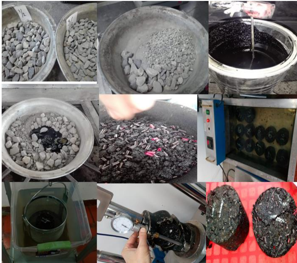
Figura 16 Procedimiento para la realización del ensayo Marshall para el diseño de mezclas asfálticas según INV E 748 – 13.
