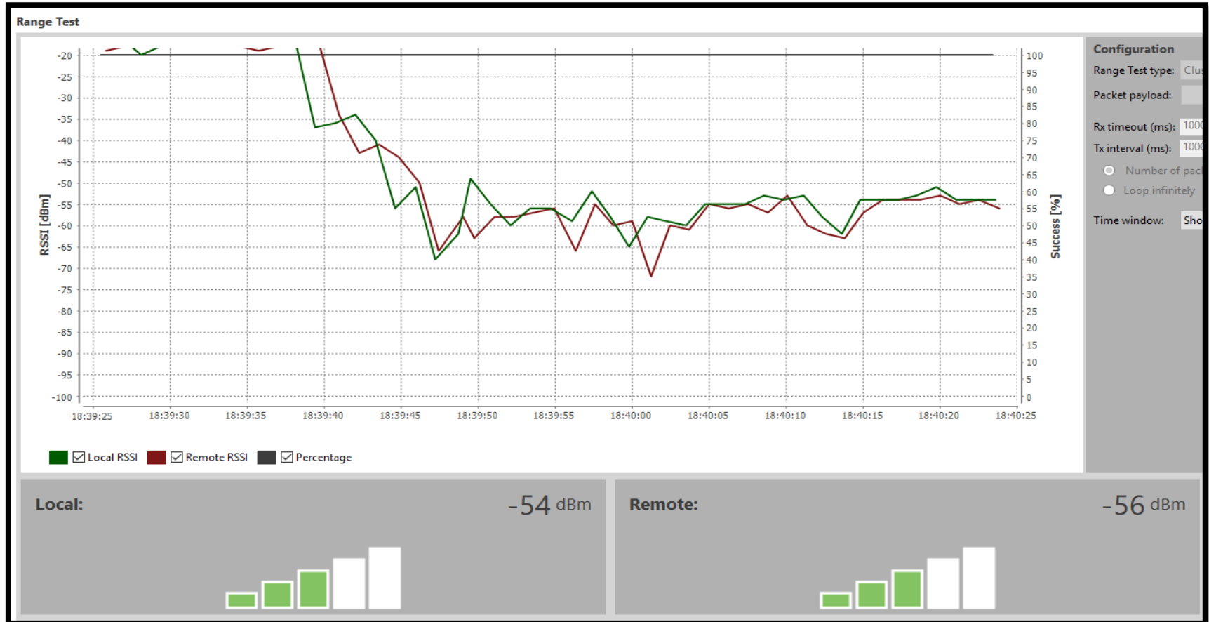
Figura 30 Prueba Xbee 60 metros
