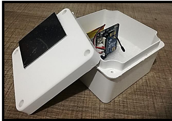
Figura 18 Modulo Xbee con celda solar
