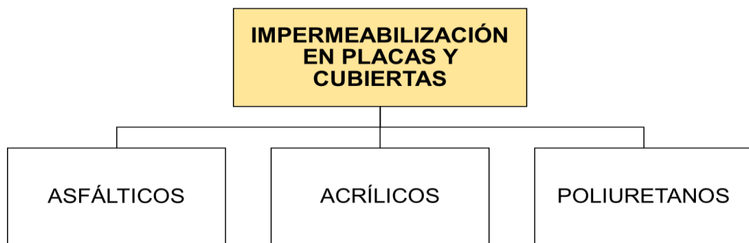
Figura 35. Impermeabilización en placas y cubiertas. Autores
