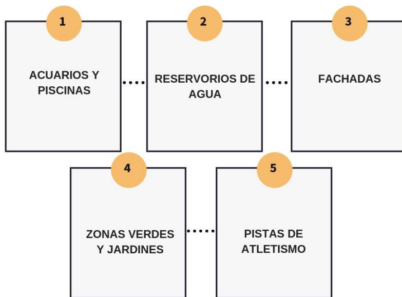
Figura 58. Aplicación de la poliurea en paisajismo y vivienda. Autores.
