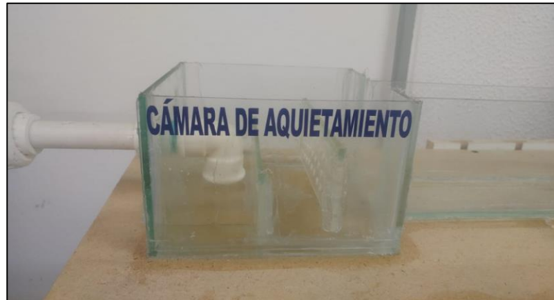
Figura 55. Cámara de Aquietamiento
