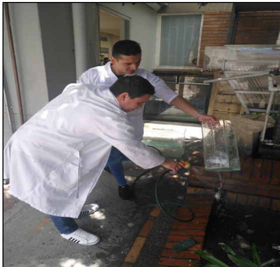
Figura 36. Limpieza de cada fase de la PTAP
