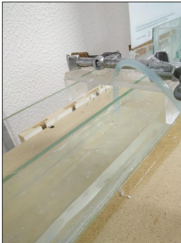
Figura 52. Construcción Canala de Transición
