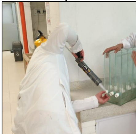
Figura 38. Refuerzo de pegante en vidrios y tuberías
