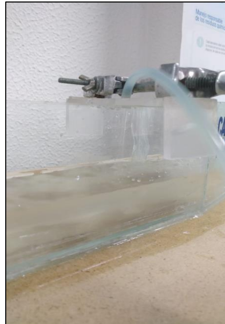
Figura 73. Entrada del Coagulante tipo B
